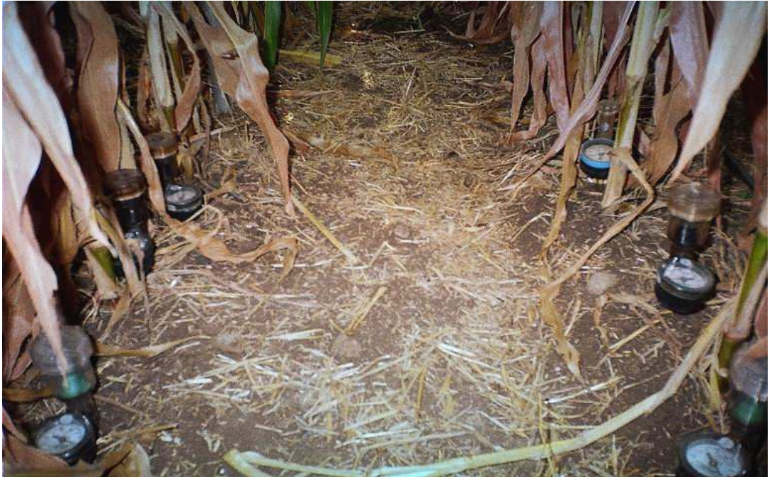
Şekil 3.2. Deneme parsellerinde oluşturulan tansiyometre bataryalarının görünümü
