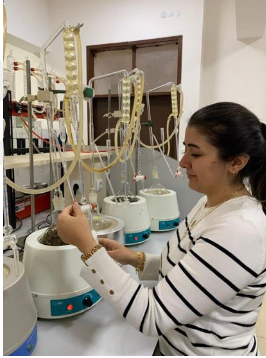
Şekil 3.7. Clevenger apareyi elde edilen uçucu yağın kılcal pipet ile alınıp hacim ölçülmesi
