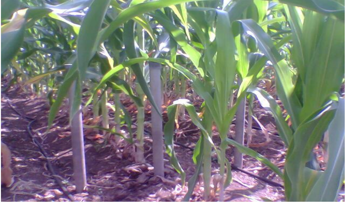
Şekil 3.2. PRD–100, PRD–75, PRD–50 Konularındaki Nötronmetre Borularının Yerleşim Düzeni
