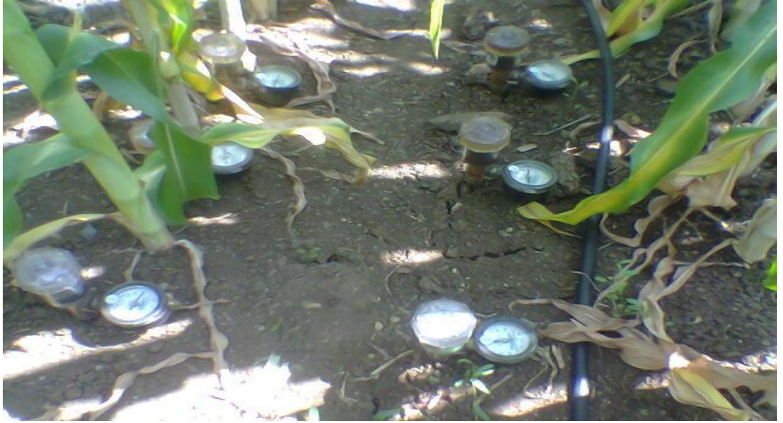
Şekil 3.3. PRD-100 Konusunda Tansiyometrelerin Yerleşimi
