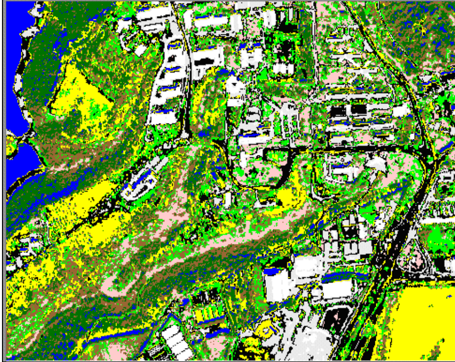
Şekil 3.22. Eğitimsiz Sınıflandırma Yöntemi Uygulanmış Çukurova Üniversitesi Quickbird Uydu Görüntüsü
