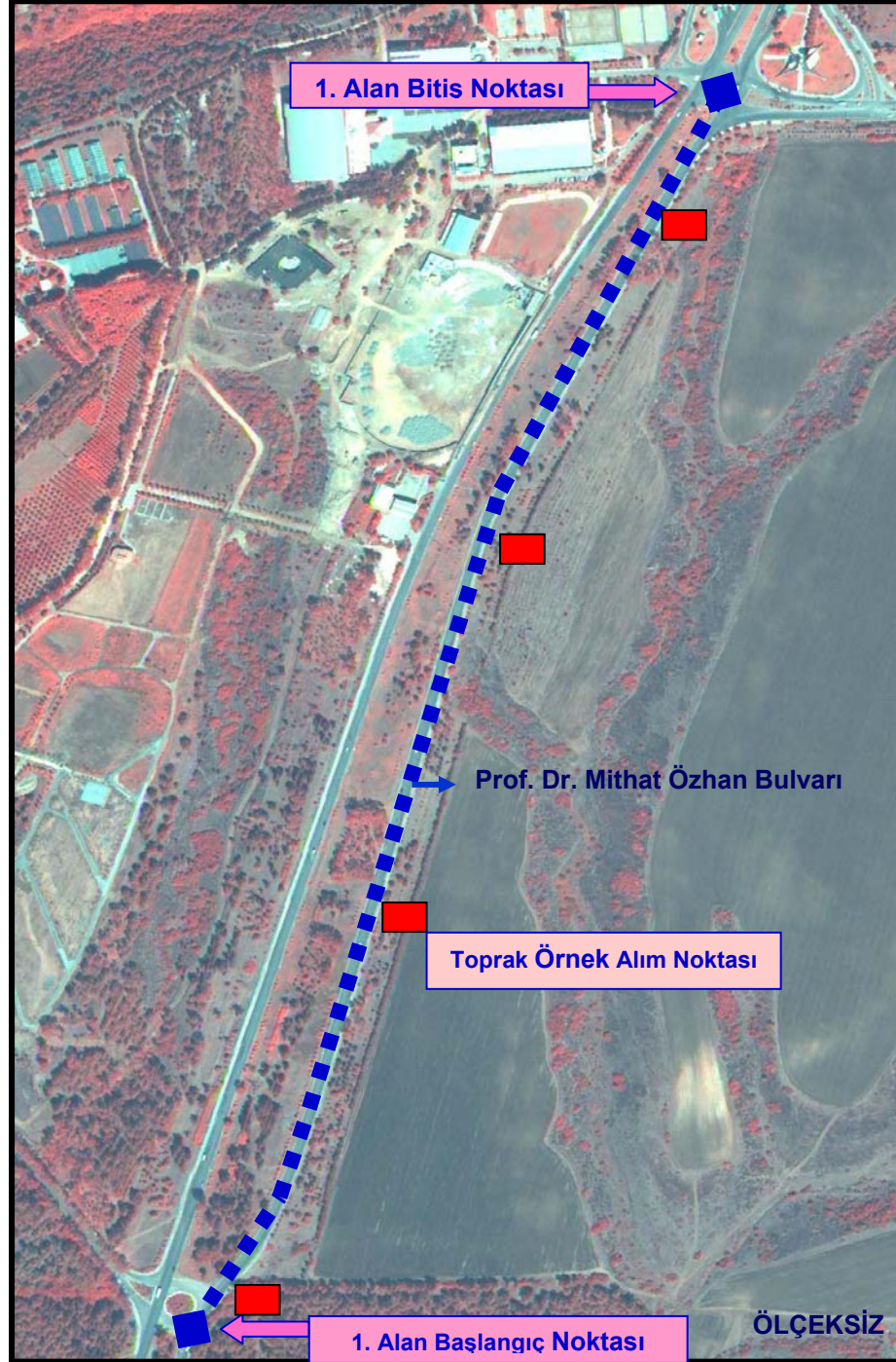
Şekil 3.22. Araştırma Alanının Birinci Bölgesinde Toprak Örneklerinin Alındığı Noktalar
