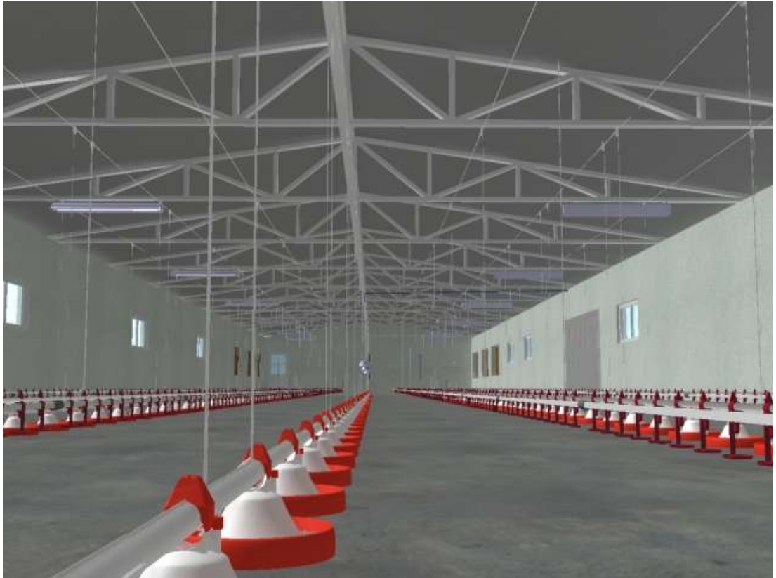
5. Şekil 3.26. Kümes İçerisine Spiral Yemlik Yerleşimi 3D- Düzgün görünümlü
