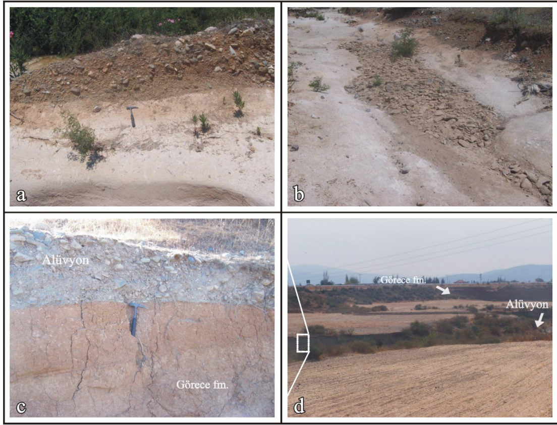
Şekil 2.15 (a) Görece doğusundaki bir akarsu kanalında gözlenen Cumaovası volkaniklerine ait tüfler ile Alüvyon birimi arasındaki uyumsuz dokanak, (b) kanal içerisindeki Alüvyon çökelleri, (c) Alüvyon birimi ile Görece formasyonu arasındaki dokanak ilişkisi, (d) Alüvyon birimi ile Görece formasyonunun arazi görünüşleri.
