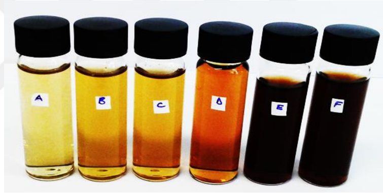
Görsel 7.1. CuO nanoparçacıklarının sentez sürecinde farklı zaman aralıklarındaki çözelti örnekleri: 0sa (a), 5sa (b), 11sa (c), 19sa (d), 24sa (e) ve 28sa (f)
