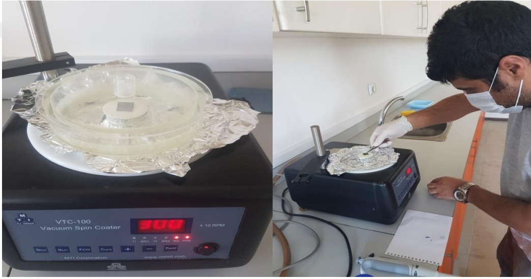
Şekil 3.6. Döndürme kaplama yöntemi ile %5 Ni katkılı CuO ve %5 Cu katkılı NiO ara yüzeyli ince filmlerin yapılması
