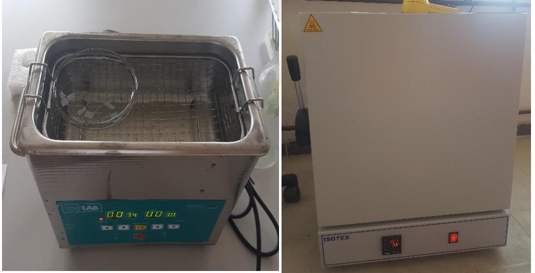
Şekil 3.1. p-tipi silisyum (Si) kristali ile cam altlık temizleme ve kurutma işlemleri
