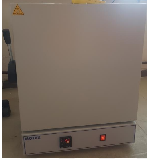
Şekil 3.7. Döndürme kaplama yöntemi ile ince filmleri yapılan numunelerin 150 °C sıcaklıktaki fırında kurutulması
