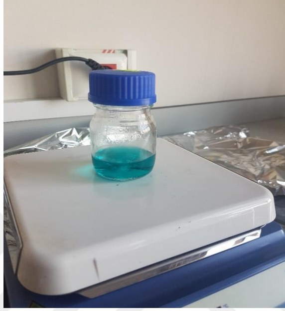
Şekil 3.5. %5 Ni katkılı CuO çözeltisine DEA damlatıldıktan sonraki son hali
