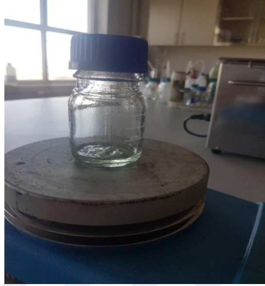
Şekil 3.3. %5Ni katkısı için NiO çözelti oluşumu (400 d/dk hızda ve 60 °C sıcaklıkta)
