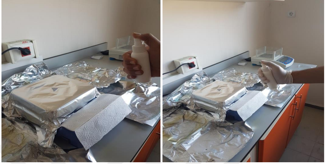
Şekil 3.8. Püskürtme yöntemi ile %5 Ni katkılı CuO ve %5 Cu katkılı NiO ara yüzeyli ince filmlerin yapılışı
