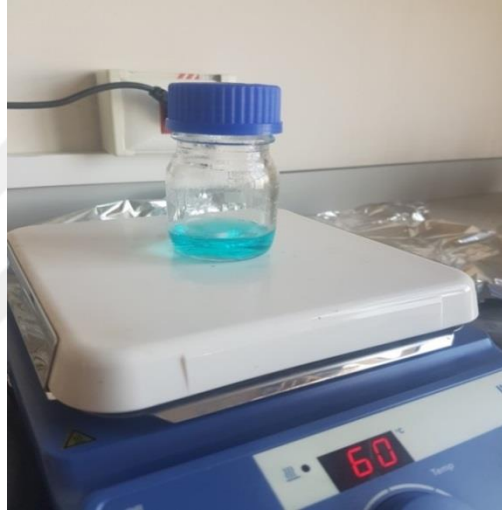
Şekil 3.2. CuO çözelti oluşumu (400 d/dk hızda ve 60 °C sıcaklıkta)
