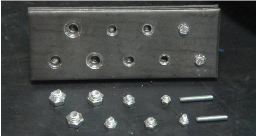
Şekil 4.41. Cıvata – Vidalı delik bağlantıları için yapılan “kopana kadar sıkma” deneyleri neticesinde kopan cıvatalar
