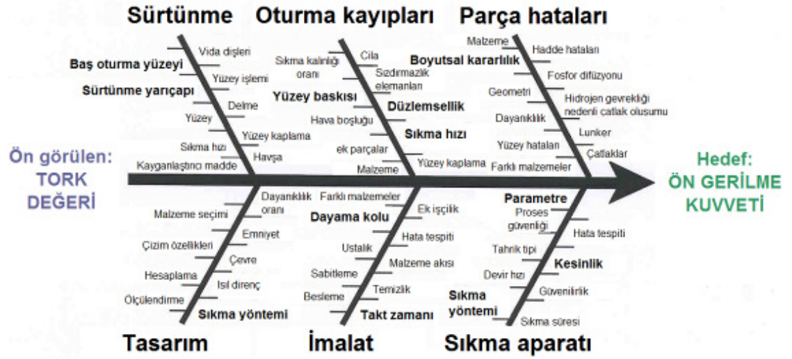
Şekil 3.3. Ön görülen tork ile hedeflenen ön gerilme kuvvetine ulaşmayı etkileyen faktörlerin balık kılçığı diyagramı şeklinde
