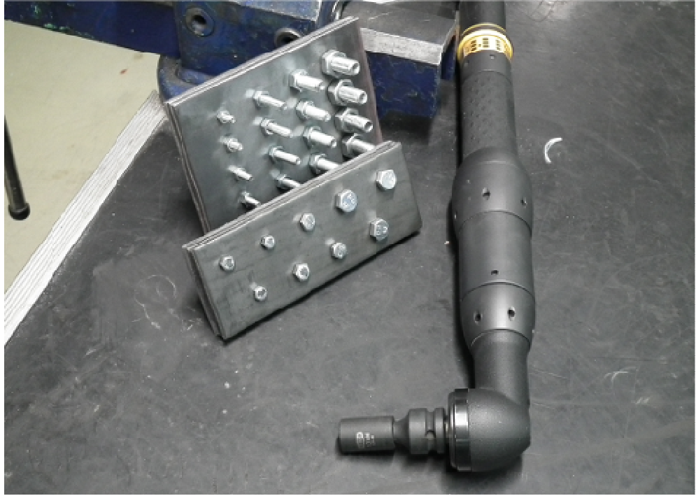
Şekil 4.38. Deneysel çalışmanın yapıldığı 100Nm kapasiteli açıcı ve tork kontrollü, %3 hassasiyete sahip sıkıcı ve test numuneleri
