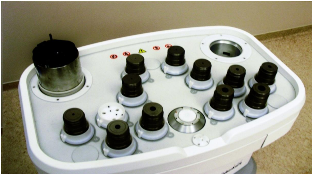
Şekil 2.3: CyberKnife sisteminde kullanılan sabit açıklıklı kolimatörler
