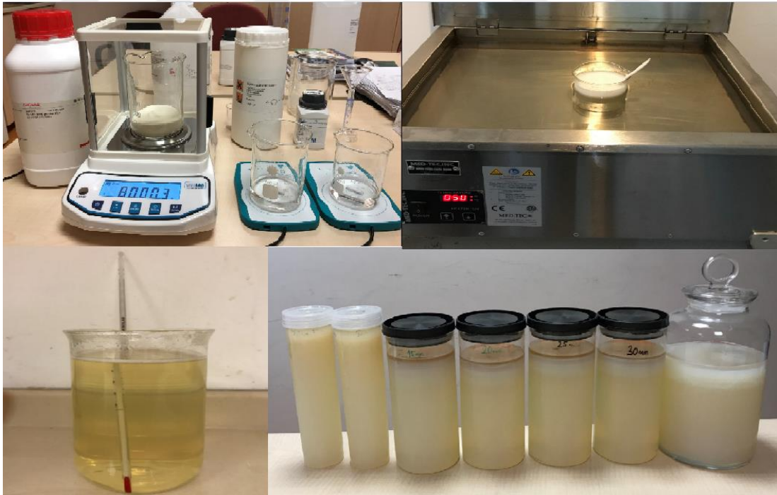
Şekil 3.15. MAGIC polimer jel dozimetrenin hazırlanması
