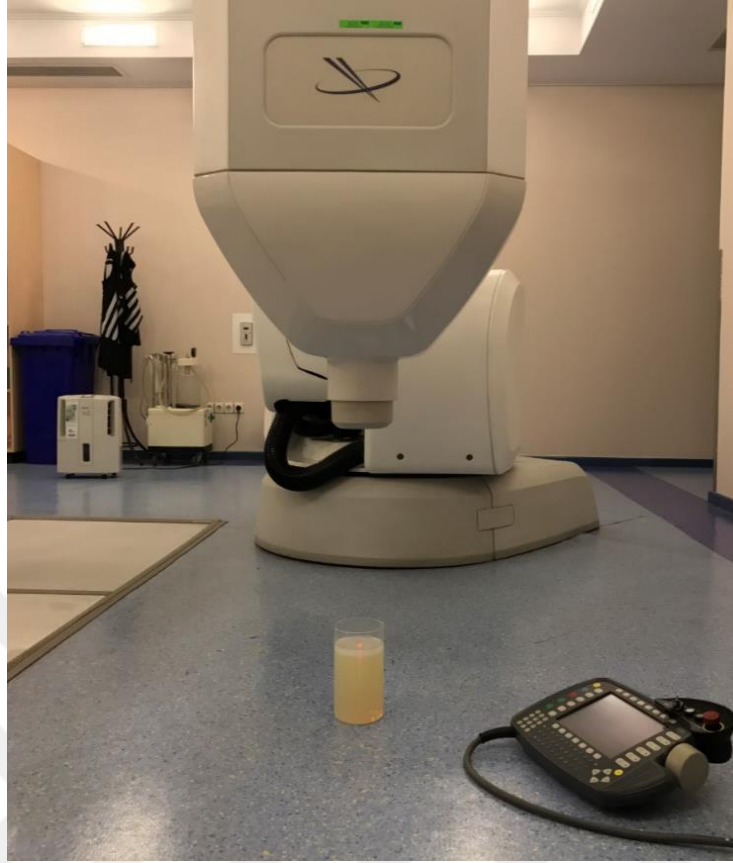
Şekil 3.17. MAGIC polimer jel dozimetre ölçüm düzeneği
