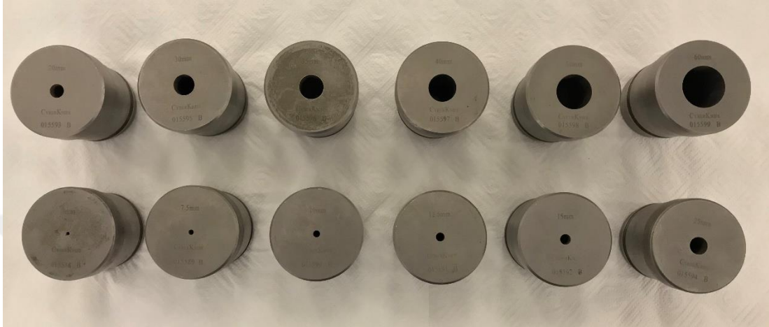
Şekil 3.2. CyberKnife robotik radyocerrahi cihazının kolimatörleri
