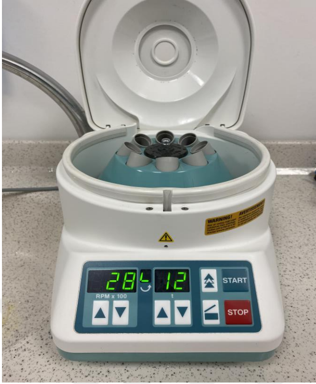
Fotoğraf 3.2: IntraSpin™ masa üstü santrifüj cihazı
