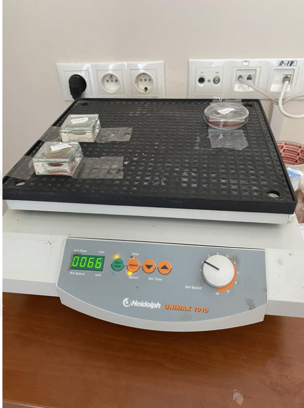
Fotoğraf 3.10: T-PRF membranların orbital çalkalama cihazındaki yerleşimi
