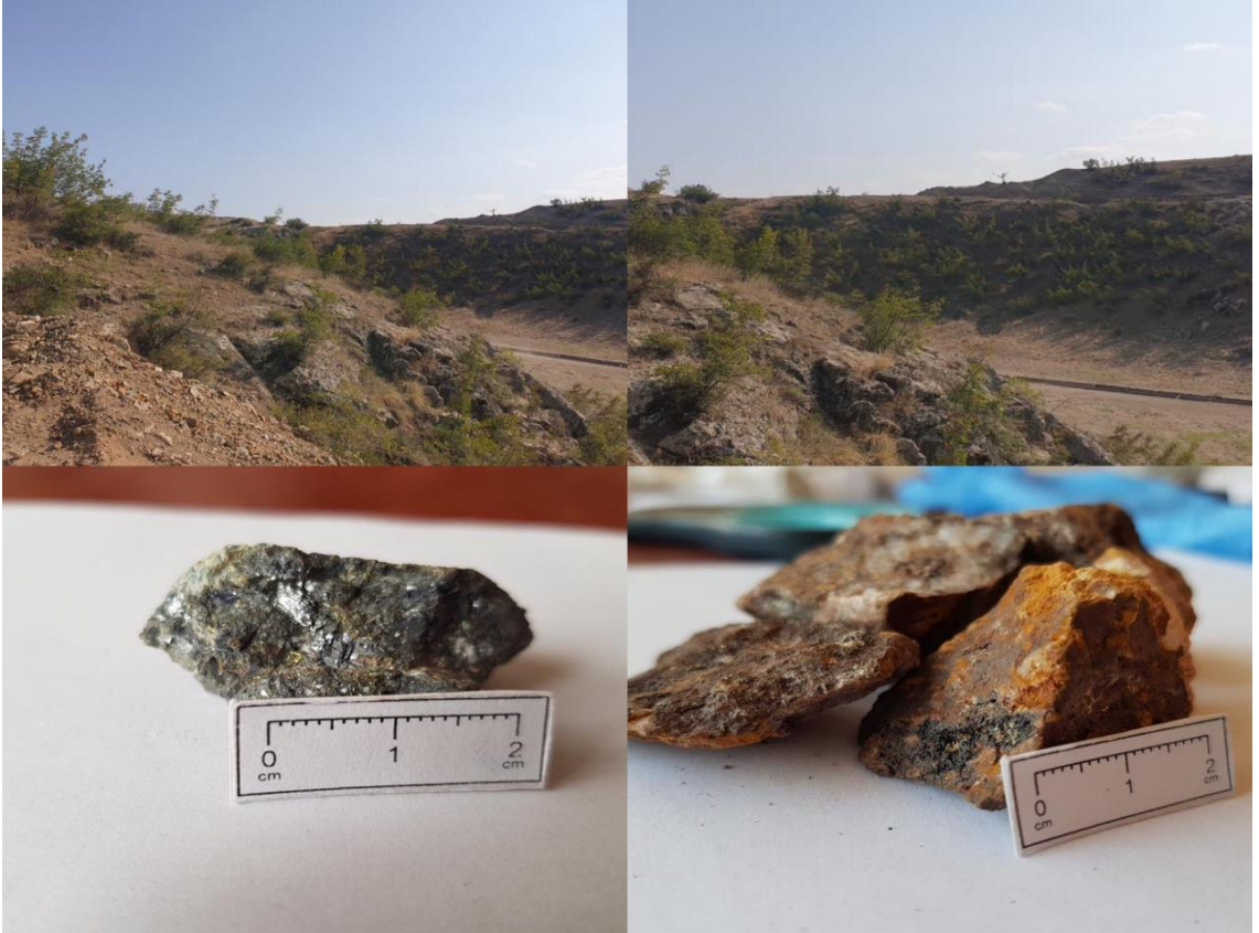
Şekil 7. Dağkesemen polimetallik Au yatağından alınan cevher ve alterasyon numuneleri
