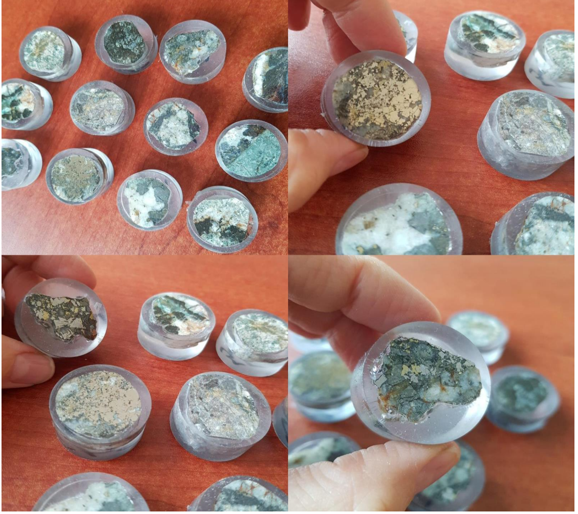
Şekil 9. Dağkesemen polimetallik Au yatağından alınan örneklerden hazırlanmış parlatma kesit fotoğrafları
