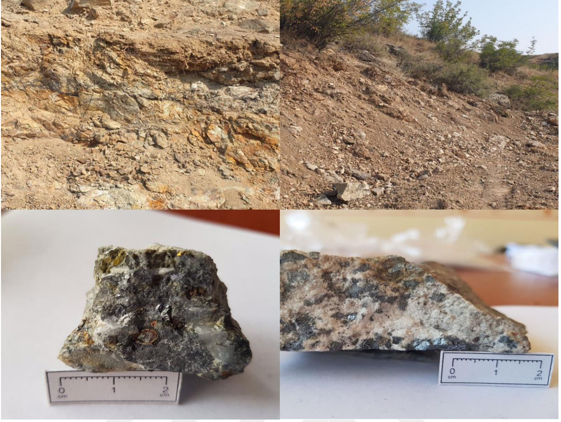
Şekil 6. Dağkesemen polimetallik Au yatağından alınan cevher ve yankayaç numuneleri
