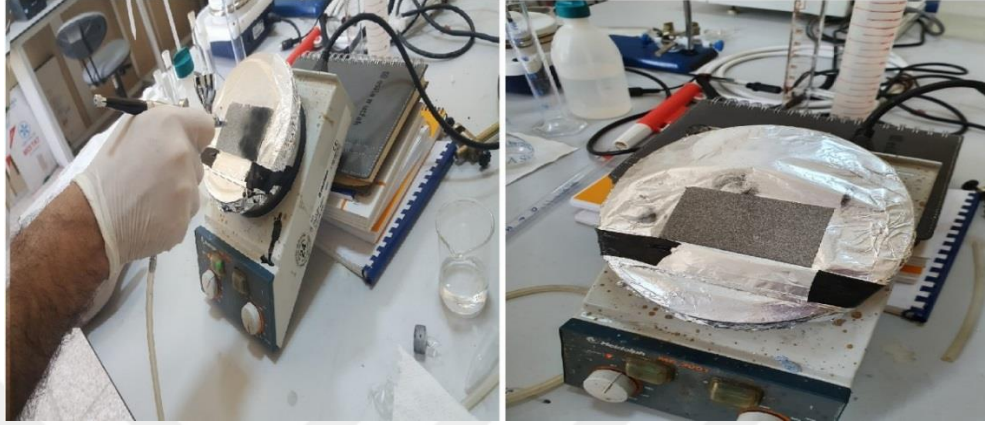
Şekil 3.5. Elektrot malzemesi için elde edilen karışımın nikel foam üzerine püskürtülme yöntemiyle uygulanması.
