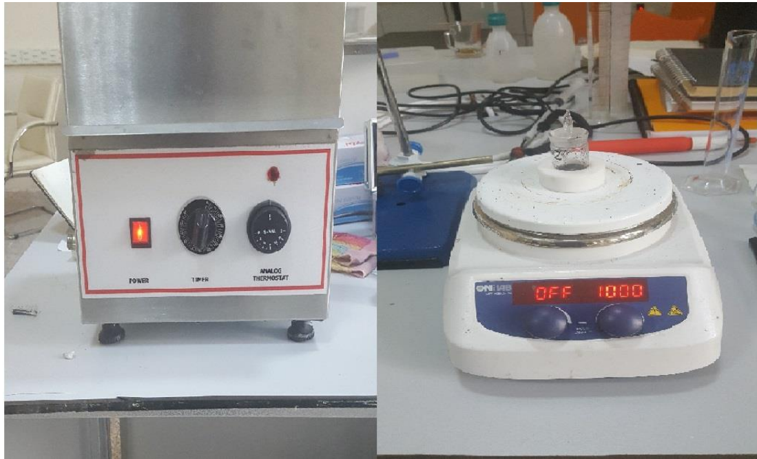
Şekil 3.4. Elektrot malzemesinin eldesi için uygulanan ultrasonik ve manyetik karıştırma işlemi.
