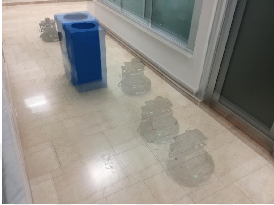
Şekil 5.10. Statik engelli ortamdaki yol planlamaya ait yol planlama adımları
