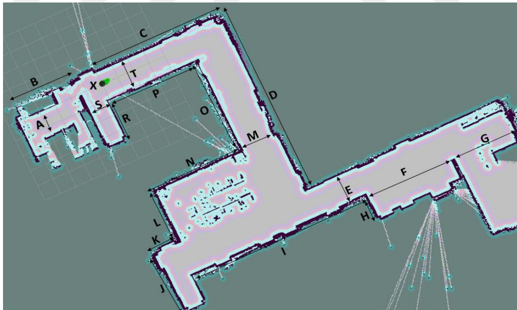
Şekil 4.3. Mekatronik Mühendisliği Bölümüne ait SLAM ile elde edilmiş kroki
