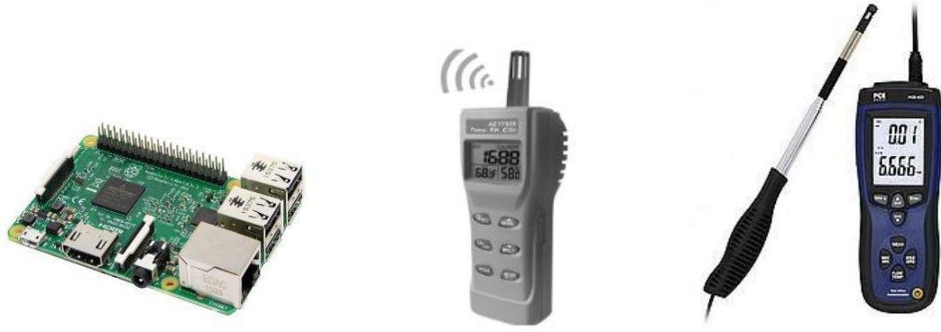
Şekil 3.3. Ölçüm düzeneğinde kullanılan cihazlar a. Raspberry Pi 3 Model B b. AZ 77535 CO 2 /Sıcaklık/RH Metre c. PCE-423 sıcak tel anemometre (Hot wire anemometer)
