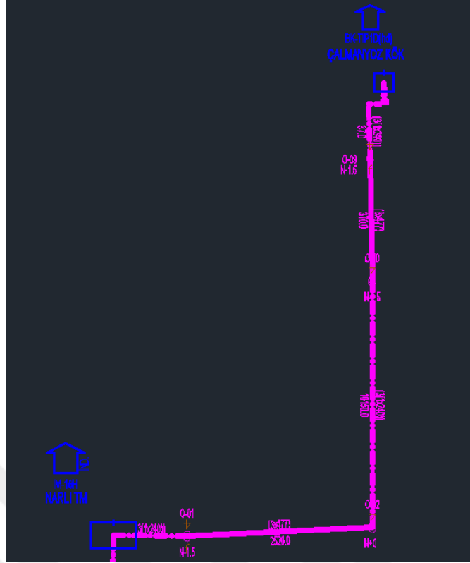
Şekil 3-5: Erdek (Narlı) TM ile Çalmanyoz KÖK arası 3x(1x240) mm 2 XLPE projesi
