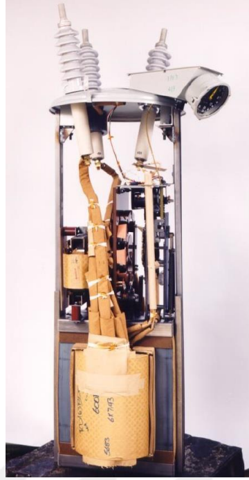
Şekil 2-8: Otomatik gerilim regülâtörünün yapısı
