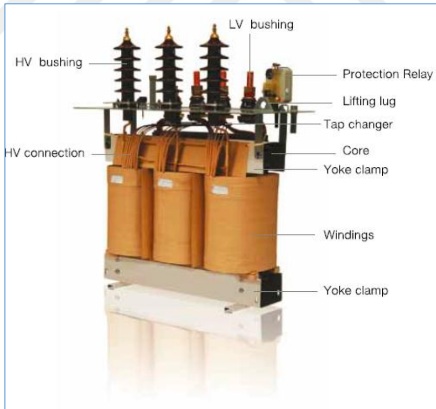
Şekil 1.2. Dağıtım transformatörü - aktif kısım
