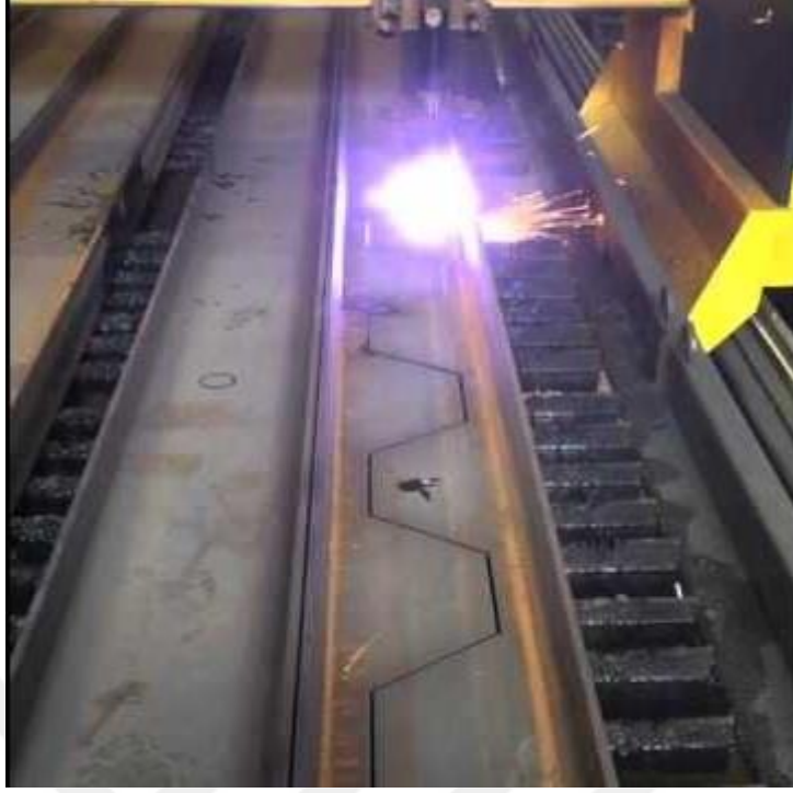
Şekil 5.2 CNC Makine ile Otomatik Kesim
