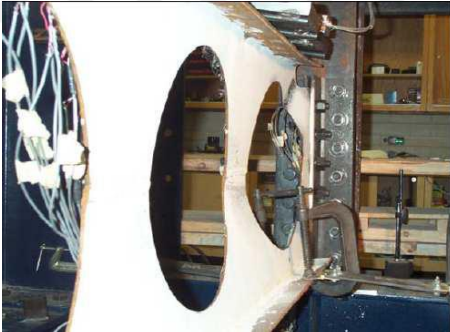
Şekil 5.11. Gövde açıklıklı kirişte gövde burkulması
