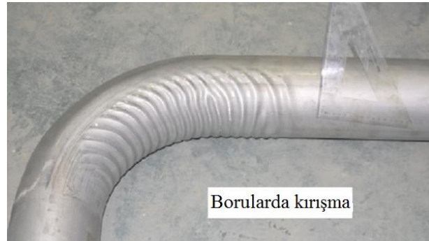
Şekil 2.12. Borularda görülen kırışma kusuru
