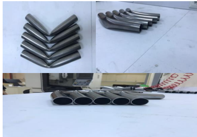
Şekil 4.5. DP800 kalite malzemelerin üç nokta eğme operasyonunda eğilmiş formları.
