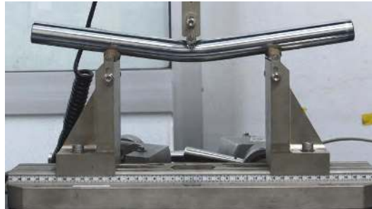
Şekil 2.10. Örnek bir boru profilinin 3 nokta eğmede şekillendirme gösterimi
