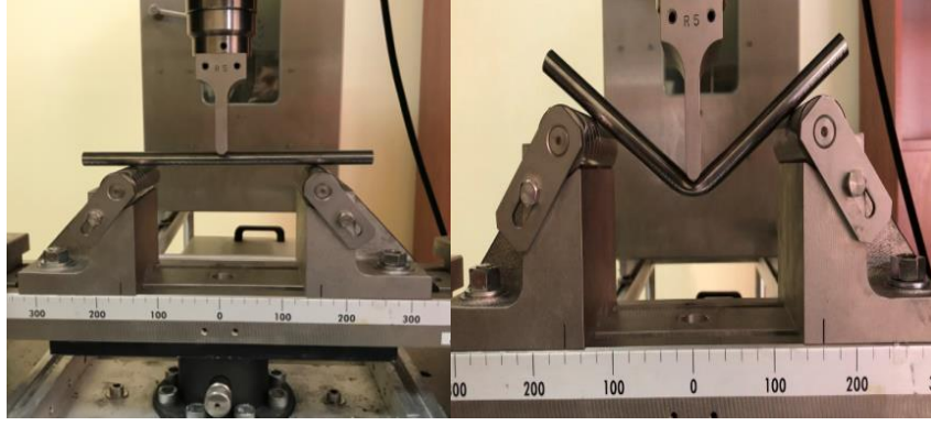
Şekil 4.3. a) Dairesel kesitli boruların çapları ve üç nokta eğme operasyonu gösterimi b) Deneyde numunelerin eğme öncesi ve sonrası.
