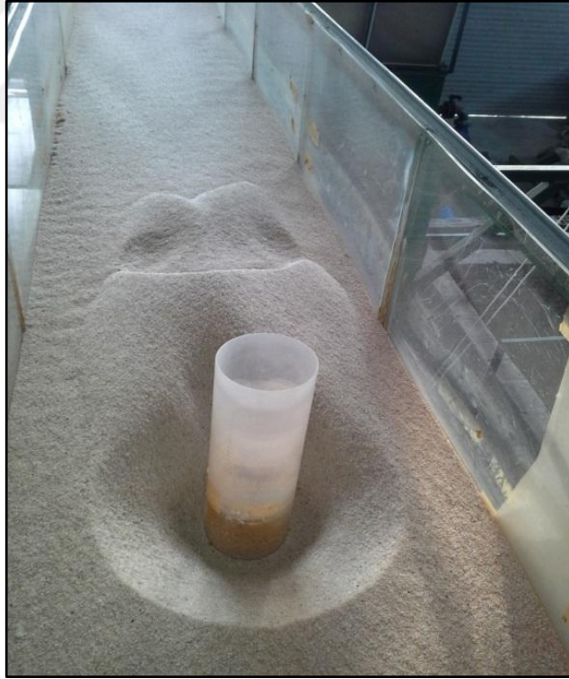
Şekil 15 D-15-4 nolu deney sonrasında elde edilen eşyükselti eğrisi ve çekilen fotoğraf
