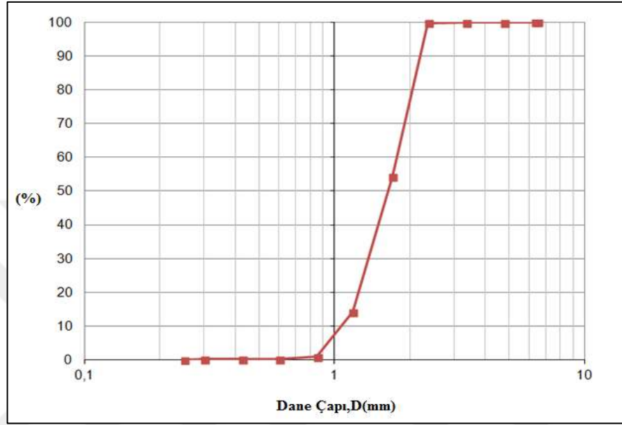
Şekil 3.2 Taban malzemesinin granülometrik eğrisi
