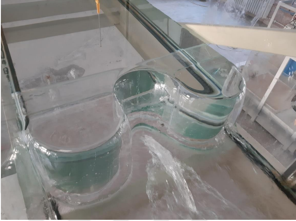
Şekil 4.12. P=20 cm için 3 asimetric daire labirent savak (Deney No: 8)
