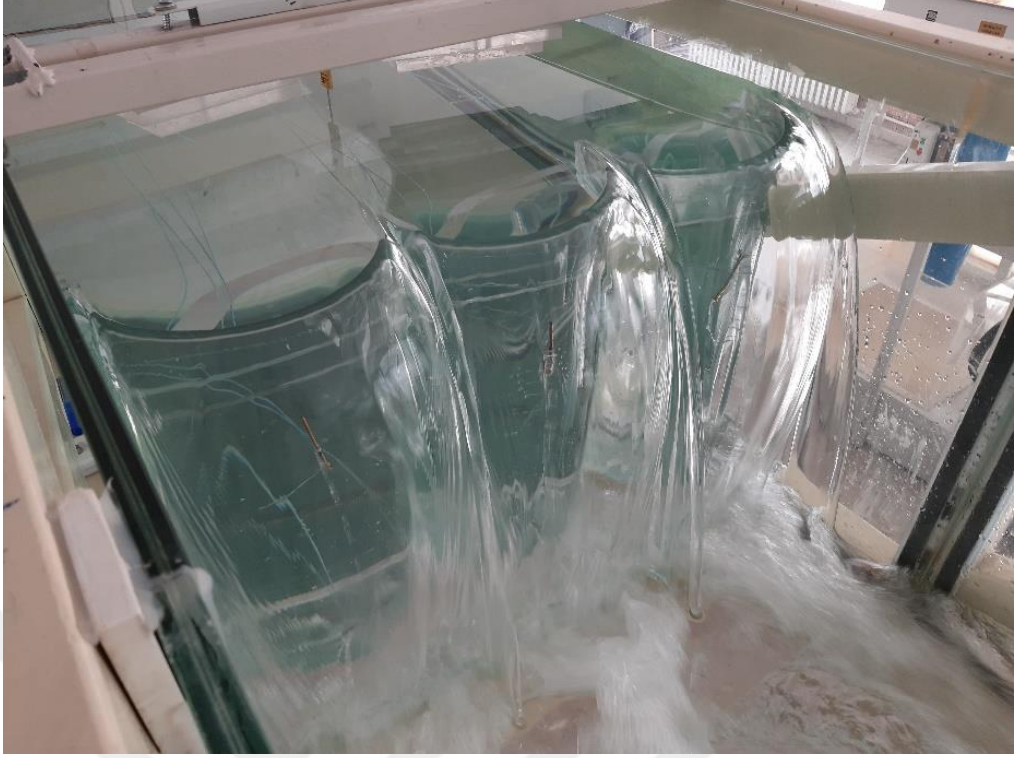
Şekil 4.24. P=40 cm için 3 düz daire labirent savak (Deney No: 20)
