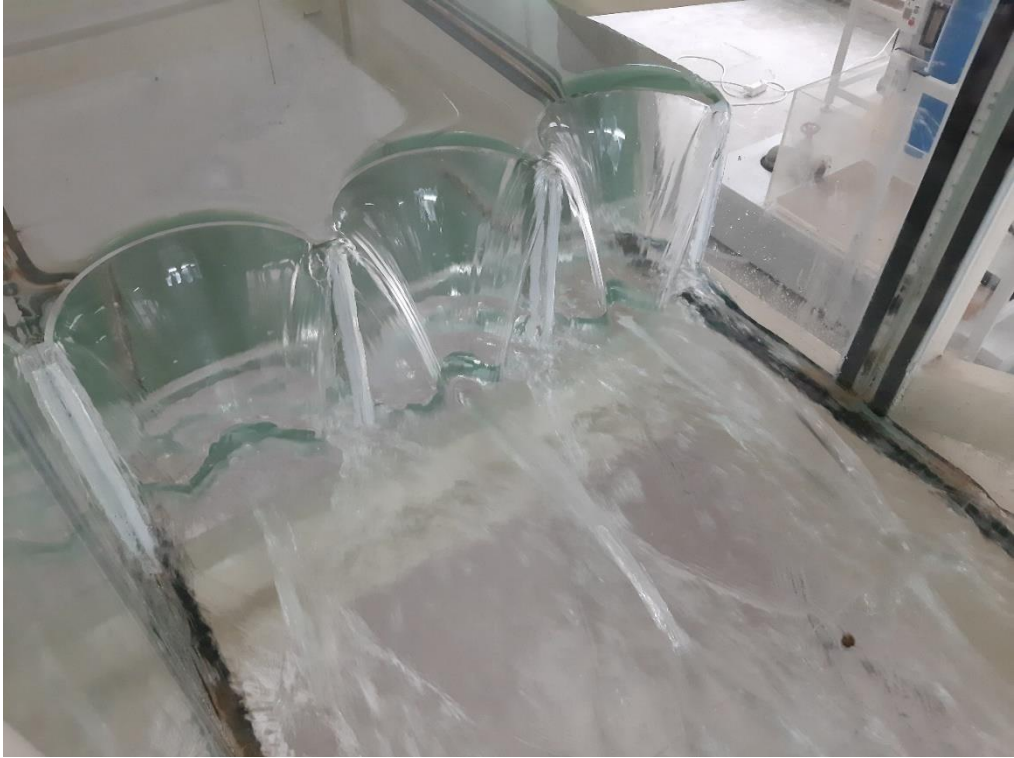
Şekil 4.9. P=20 cm için 3 ters daire labirent savak (Deney No: 5)
