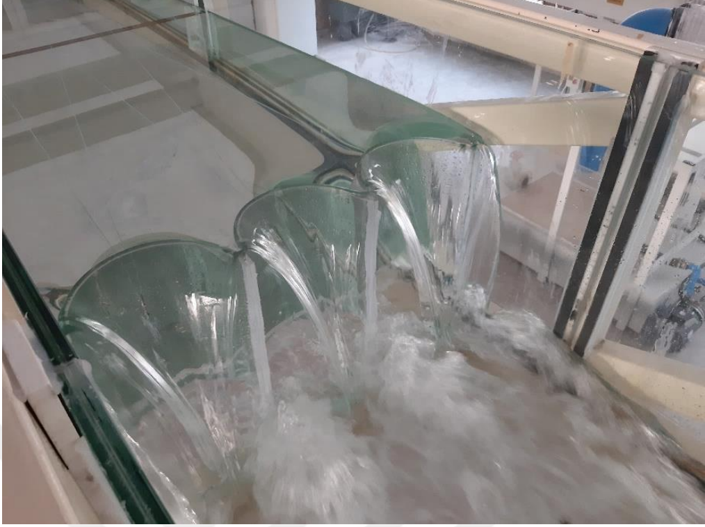
Şekil 4.18. P=30 cm için 3 ters daire labirent savak (Deney No: 14)
