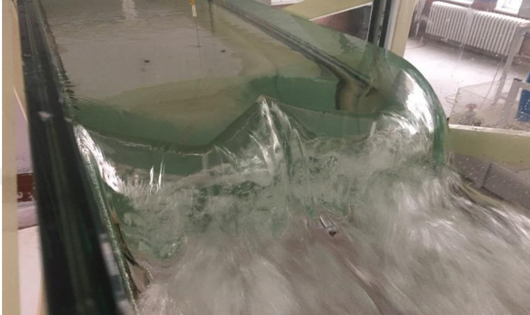
Şekil 2.3. Üçgen savaklarda yüksek debilerde nap akımlarının oluşturduğu girişim
