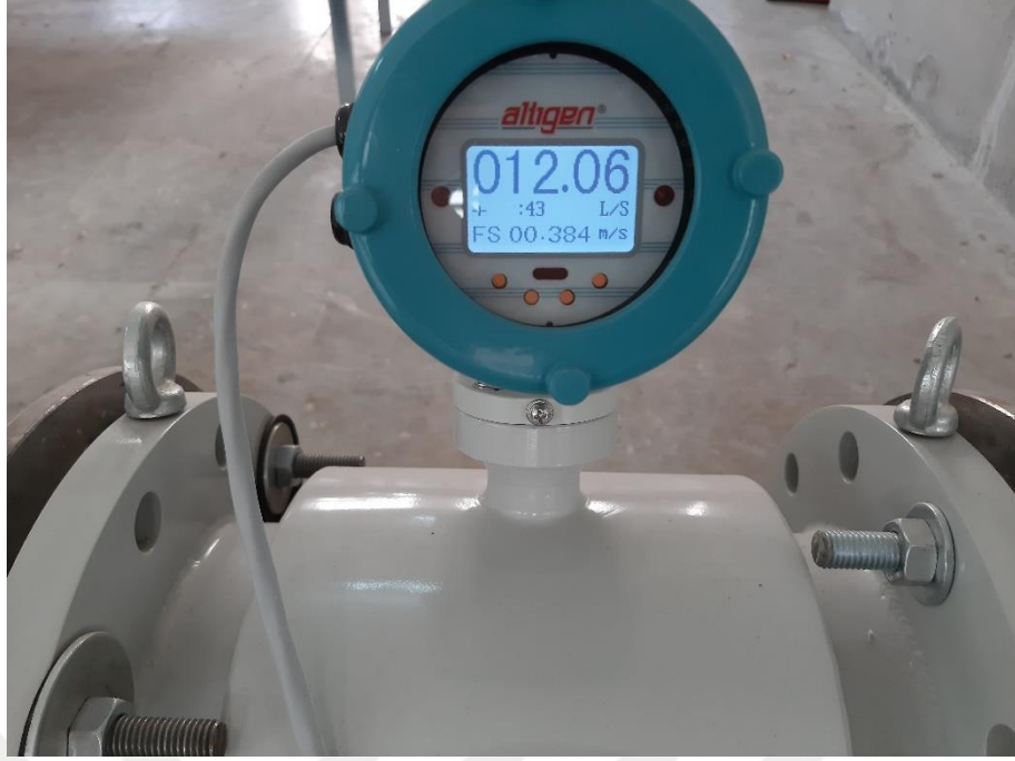
Şekil 4.48. Debi ölçümünde kullanılan ultrasonik debimetre
