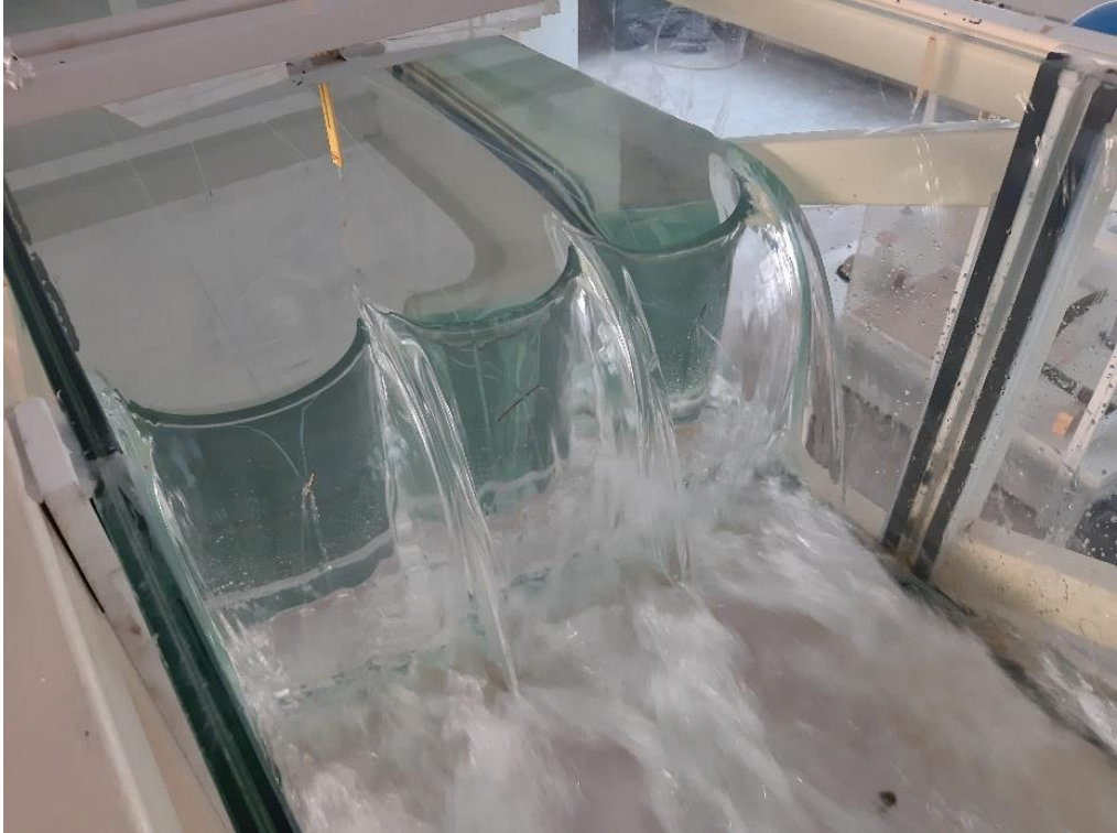
Şekil 4.15. P=30 cm için 3 düz daire labirent savak (Deney No: 11)
