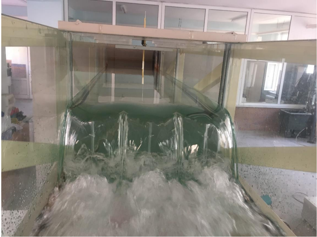
Şekil 4.36. P=20 cm için 3 düz üçgen labirent savak (Deney No: 32)
