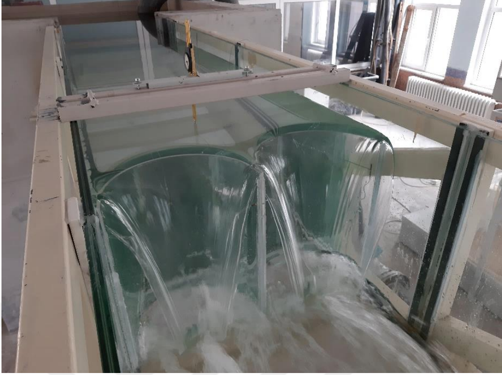
Şekil 4.26. P=40 cm için 2 ters daire labirent savak (Deney No: 22)
