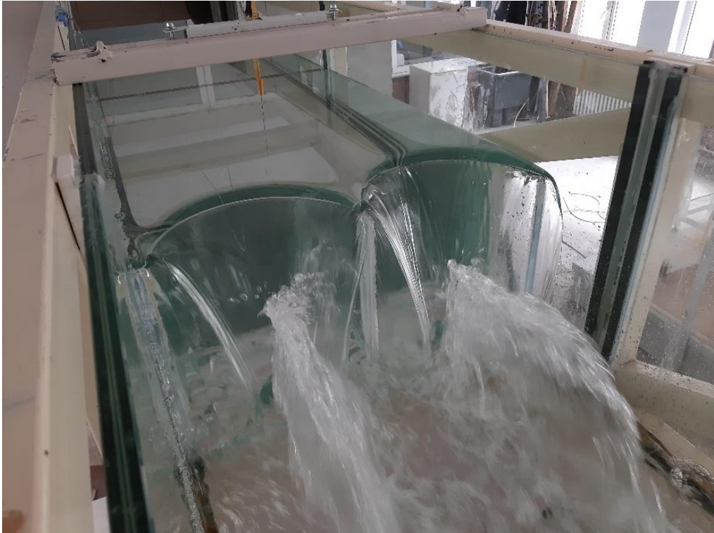
Şekil 4.17. P=30 cm için 2 ters daire labirent savak (Deney No: 13)
