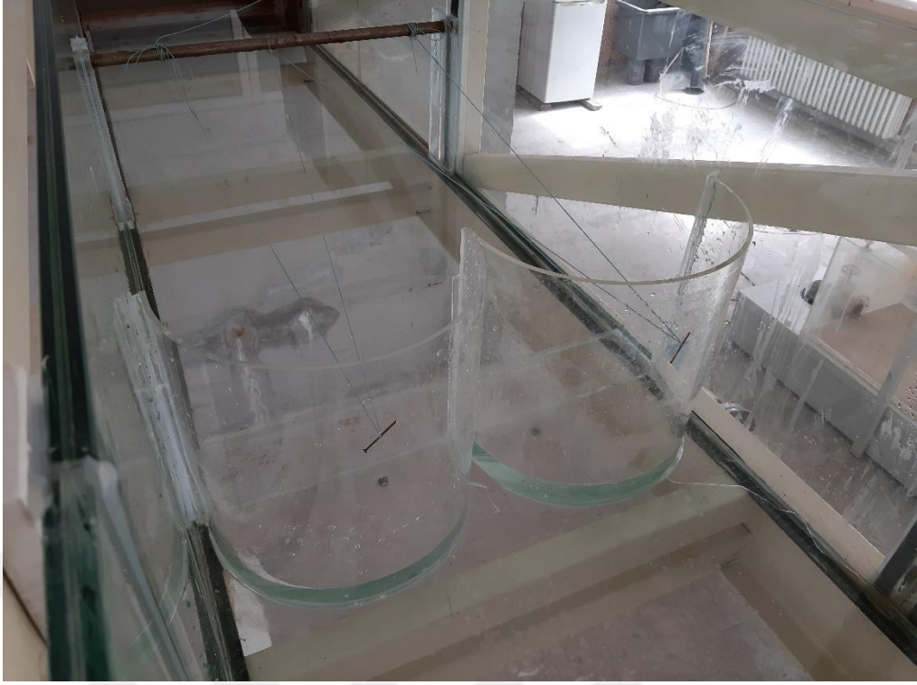
Şekil 4.14. P=30 cm için 2 düz daire labirent savak (Deney No: 10)
