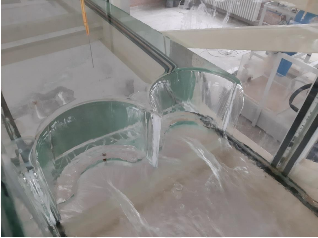
Şekil 4.8. P=20 cm için 2 ters daire labirent savak (Deney No: 4)
