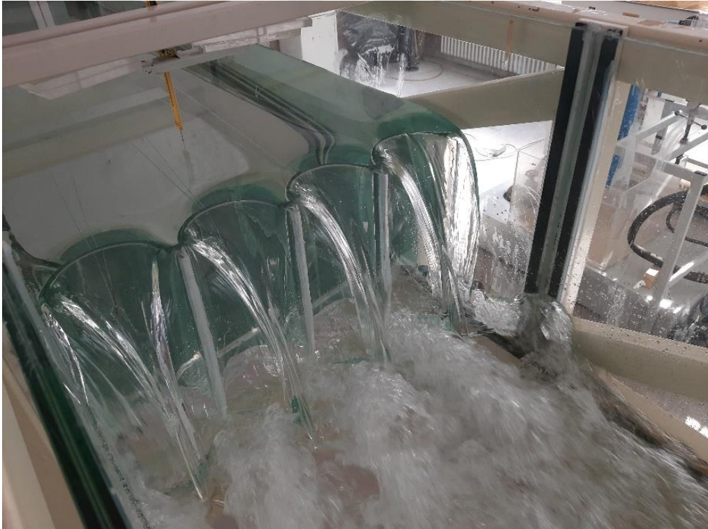
Şekil 4.19. P=30 cm için 4 ters daire labirent savak (Deney No: 15)
