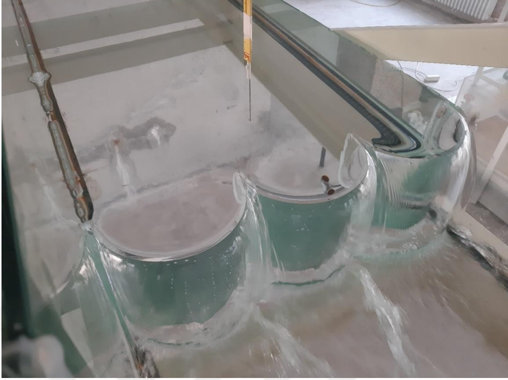
Şekil 4.6. P=20 cm için 3 düz daire labirent savak (Deney No: 2)
