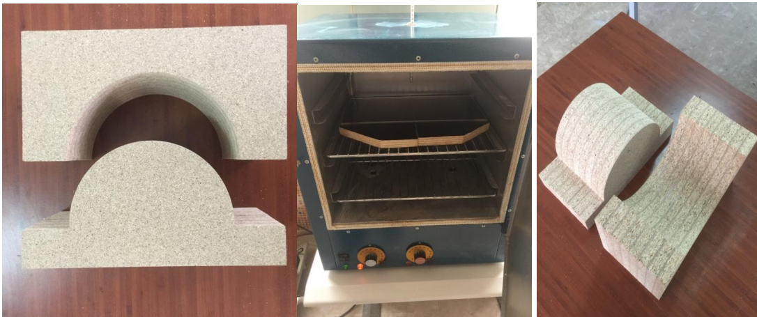
Şekil 4.4. Pleksiglas tabakaların etüvde ısıtılarak kalıplarda şekillenmesi
