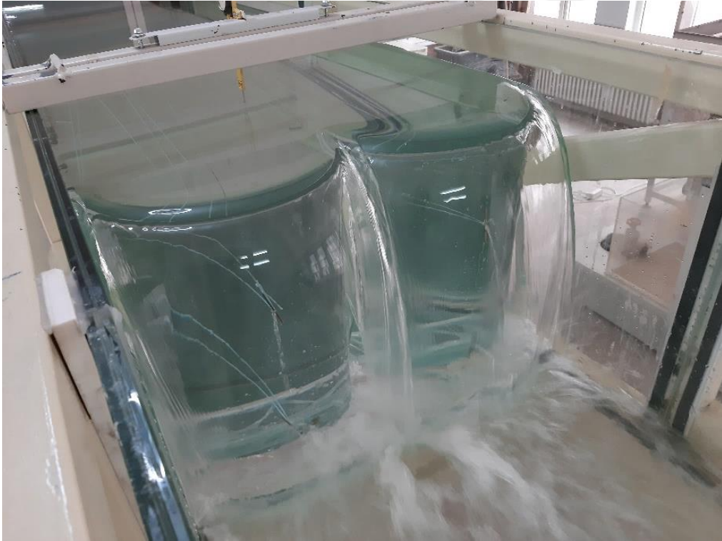
Şekil 4.23. P=40 cm için 2 düz daire labirent savak (Deney No: 19)
