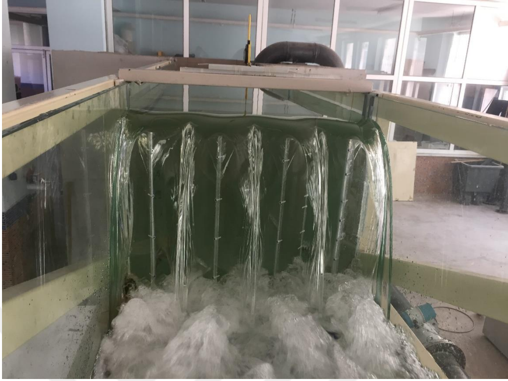
Şekil 4.43. P=40 cm için 4 düz üçgen labirent savak (Deney No: 39)
