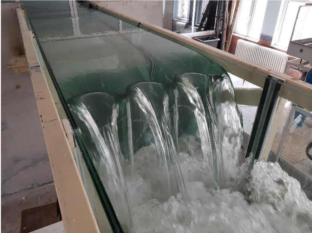
Şekil 4.27. P=40 cm için 3 ters daire labirent savak (Deney No: 23)
