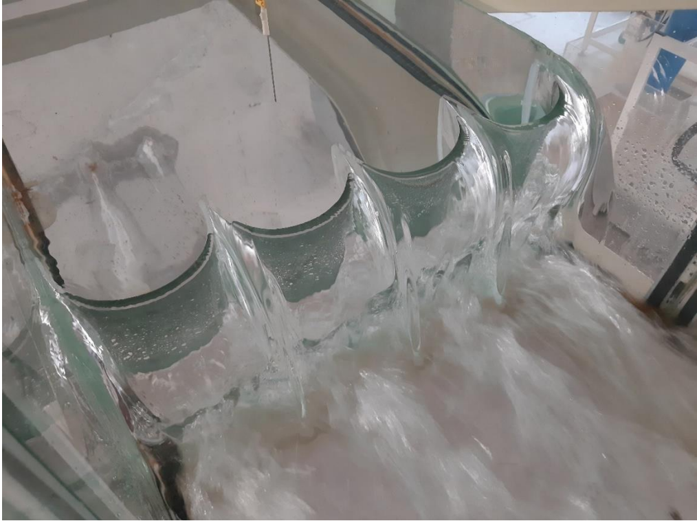
Şekil 4.7. P=20 cm için 4 düz daire labirent savak (Deney No: 3)
