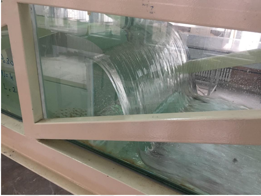
Şekil 4.32. P=30 cm için düz savak ile yapılan deney (Deney No: 29)
