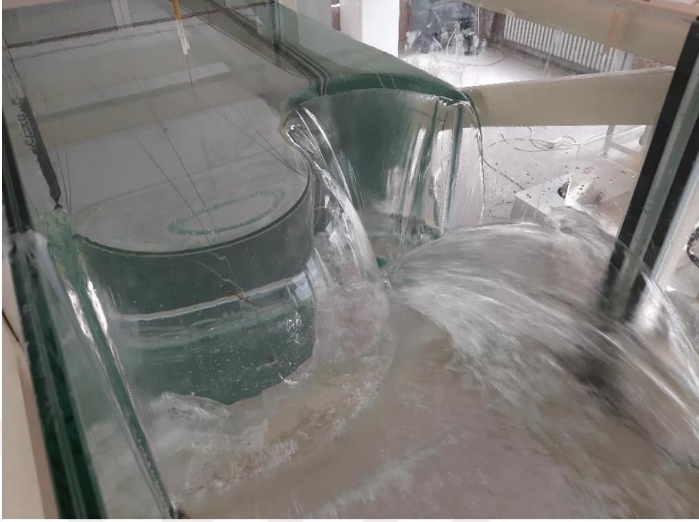
Şekil 4.20. P=30 cm için 2 asimetric daire labirent savak (Deney No: 16)
