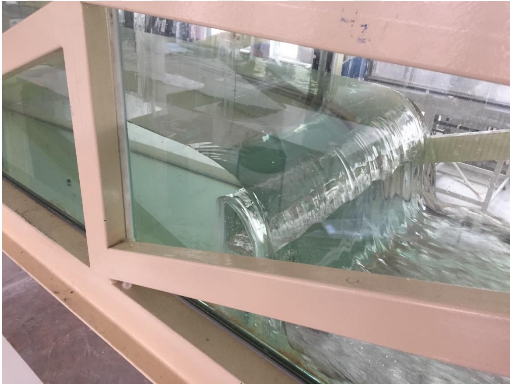
Şekil 4.31. P=20 cm için düz savak ile yapılan deney (Deney No: 28)
