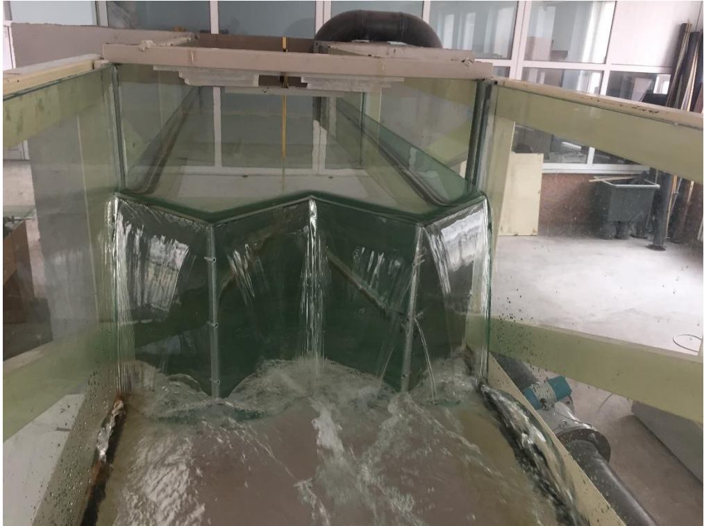
Şekil 4.38. P=30 cm için 2 düz üçgen labirent savak (Deney No: 34)
