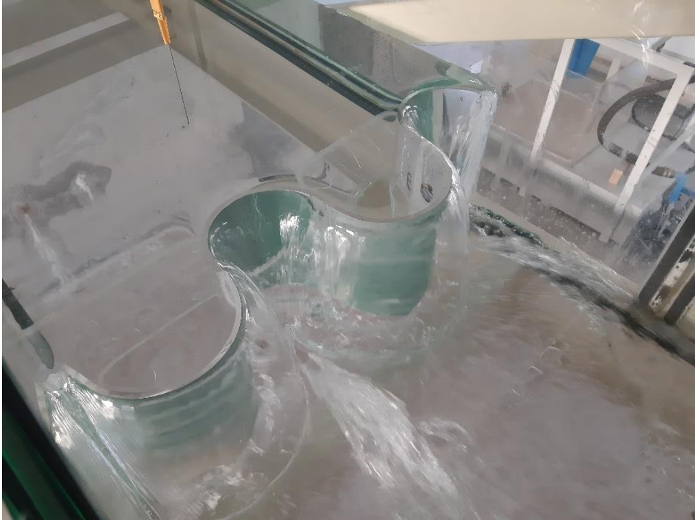
Şekil 4.13. P=20 cm için 4 asimetric daire labirent savak (Deney No: 9)
