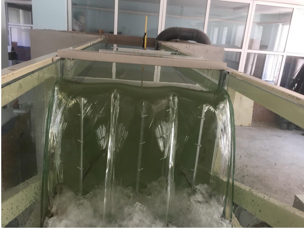
Şekil 4.42. P=40 cm için 3 düz üçgen labirent savak (Deney No: 38)
