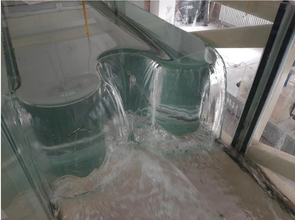
Şekil 4.21. P=30 cm için 3 asimetric daire labirent savak (Deney No: 17)
