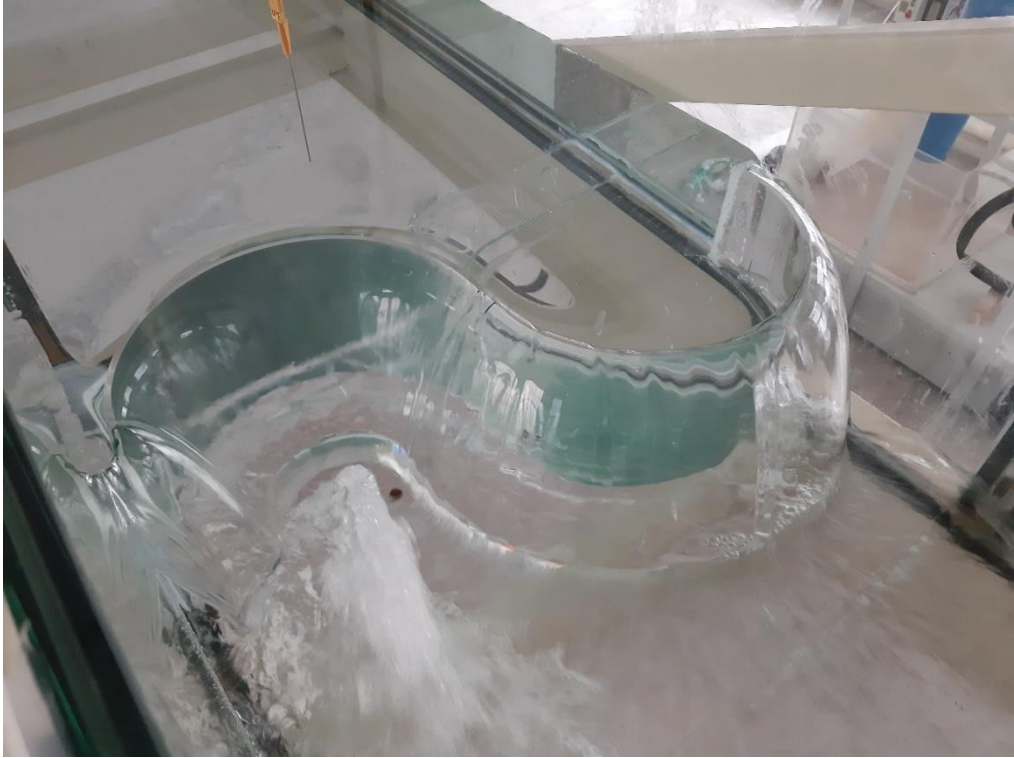
Şekil 4.11. P=20 cm için 2 asimetrik daire labirent savak (Deney No: 7)
