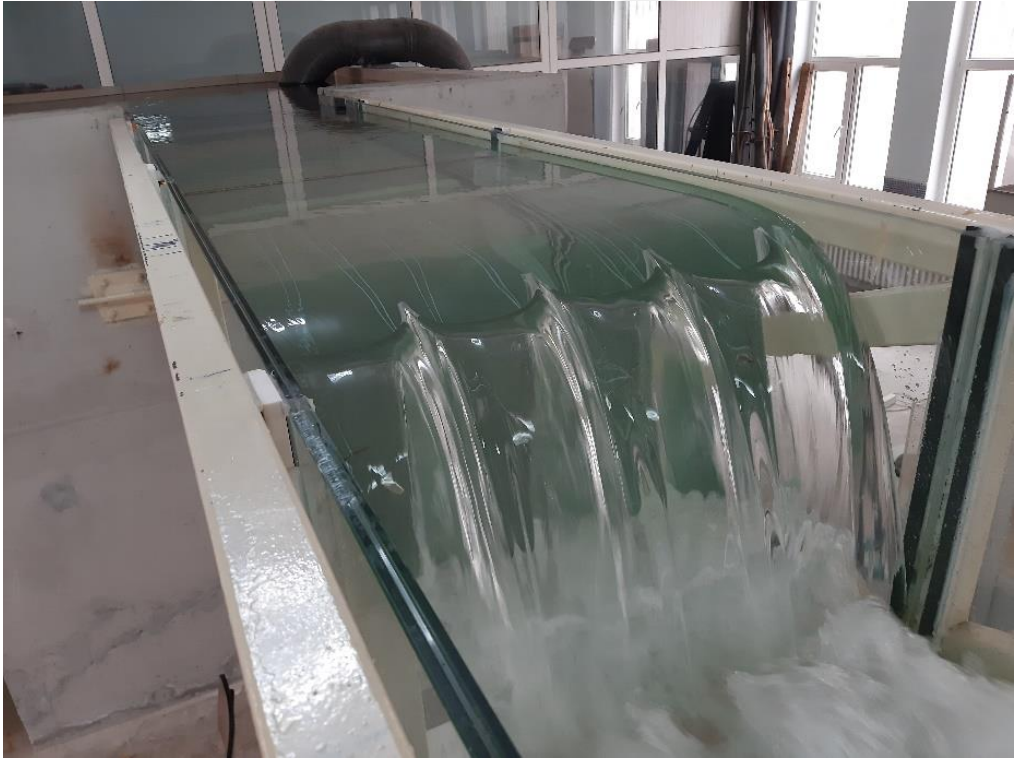
Şekil 4.25. P=40 cm için 4 düz daire labirent savak (Deney No: 21)
