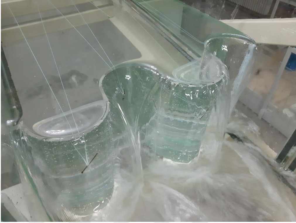
Şekil 4.22. P=30 cm için 4 asimetrik daire labirent savak (Deney No: 18)
