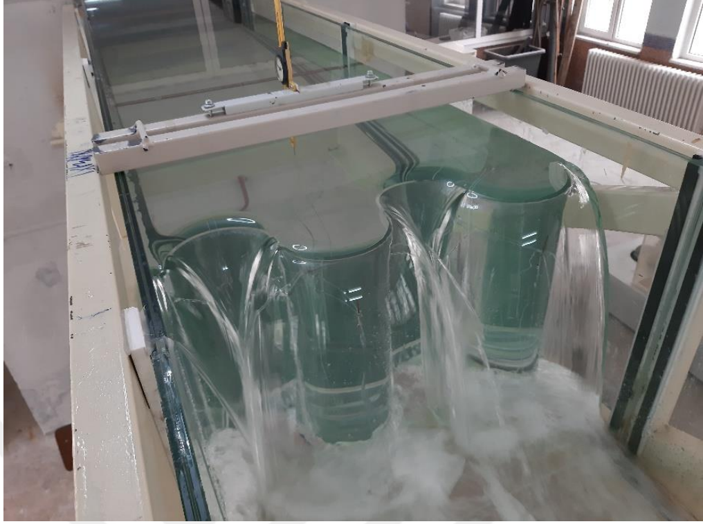
Şekil 4.30. P=40 cm için 4 asimetrik daire labirent savak (Deney No: 27)
