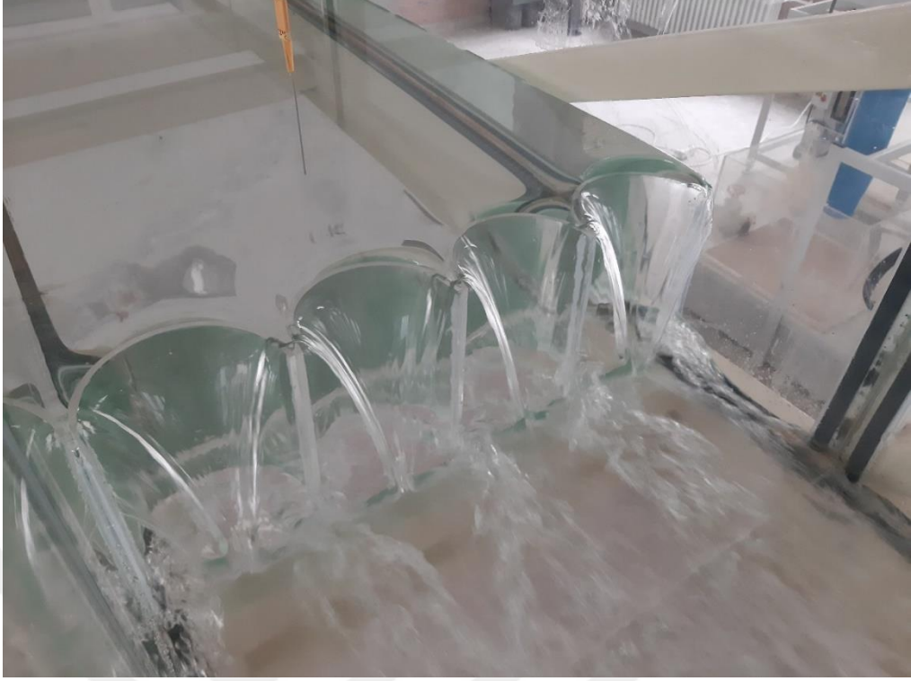
Şekil 4.10. P=20 cm için 4 ters daire labirent savak (Deney No: 6)
