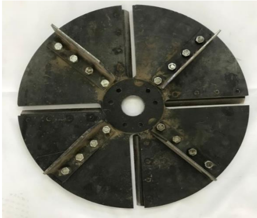
Şekil 3.4 Diskin arka yüzeyine fan görevini görmek için yerleştiren kanatlar
