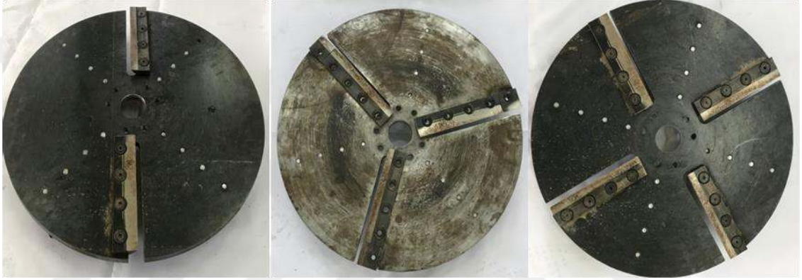
Şekil 3.3 Çalışmada kullanılan (iki, üç ve dört bıçaklı) dal parçalama bıçakları
