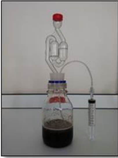
Şekil 3.5. Maya çoğaltma işleminde kullanılan maya reaktörü
