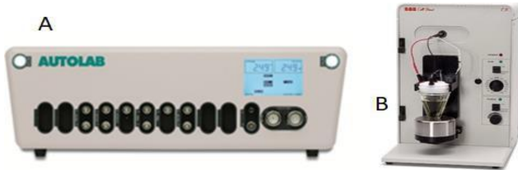
Şekil 3.1. Elektrokimyasal analiz cihazı (A) ve üç elektrotlu hücre ünitesi (B)
