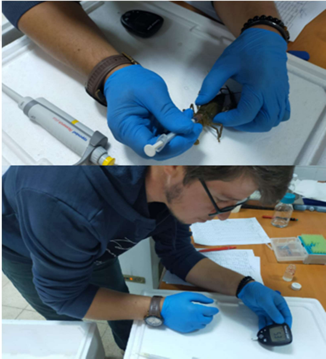
Şekil 3.5. Tatlısu ıstakozlarından hemolenf alımı ve glukoz ölçümü
