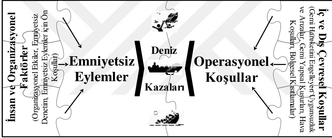
Şekil 4. HFACS-PV yapısına göre deniz kazalarının genel oluşum şeması
