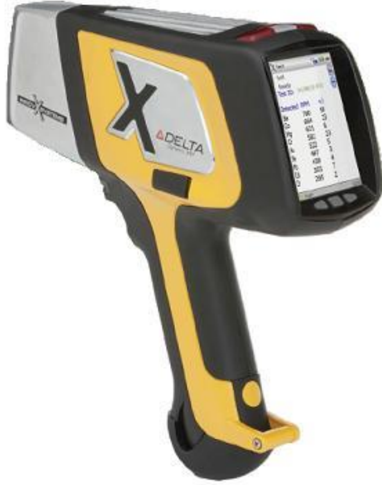
Şekil 3.4. Batman Üniversitesi Arkeometri Anabilim Dalı bünyesinde bulunan Taşınabilir Enerji Dağılımlı X-Işınlari Floresans Spektrometresi (P-EDXRF)
