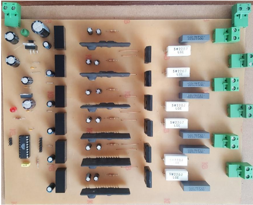
Şekil 4.12 Üç fazlı AA kıyıcı devresinin bütün hali
