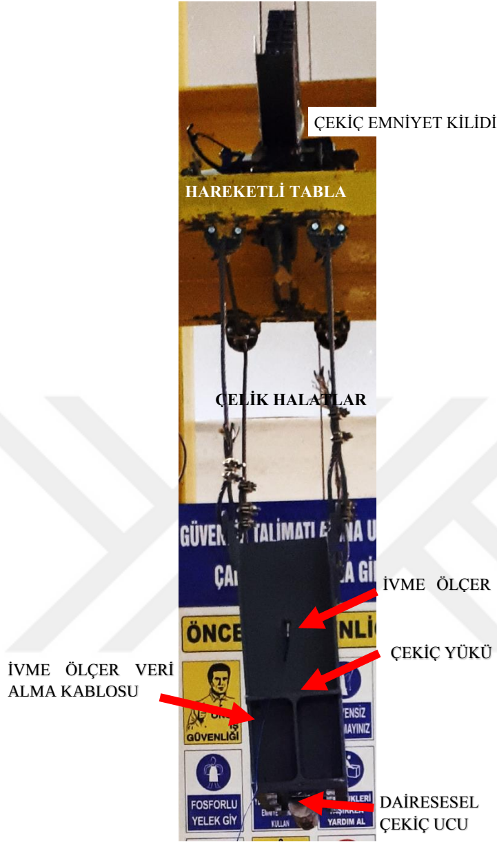
Şekil 3.13. Çekiç Yüğü ve Çekiç Sistemi
