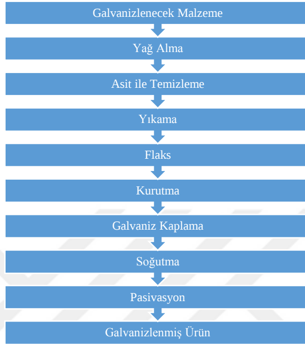
Şekil 2.1. Metal Kaplama Prosesi Akış Şeması
