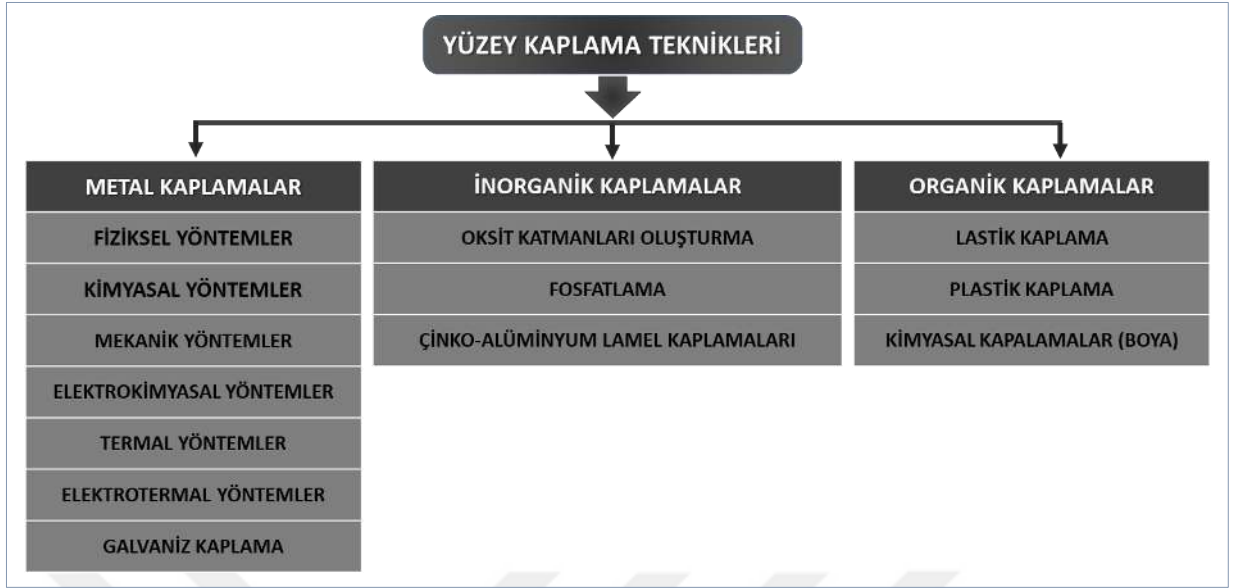
Şekil 17. Yüzey kaplama tekniklerinin genel sınıflandırılması [29].
