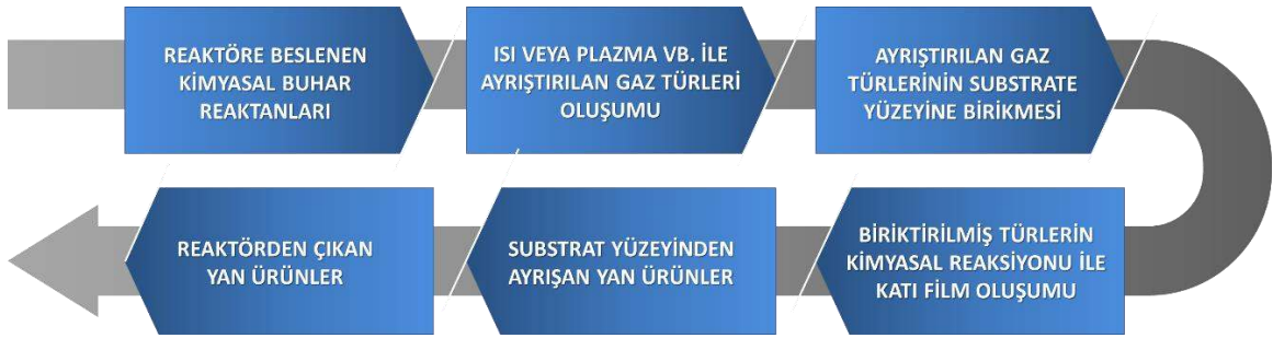
Şekil 21. CVD kaplama sürecinin genel akış şeması [42].
