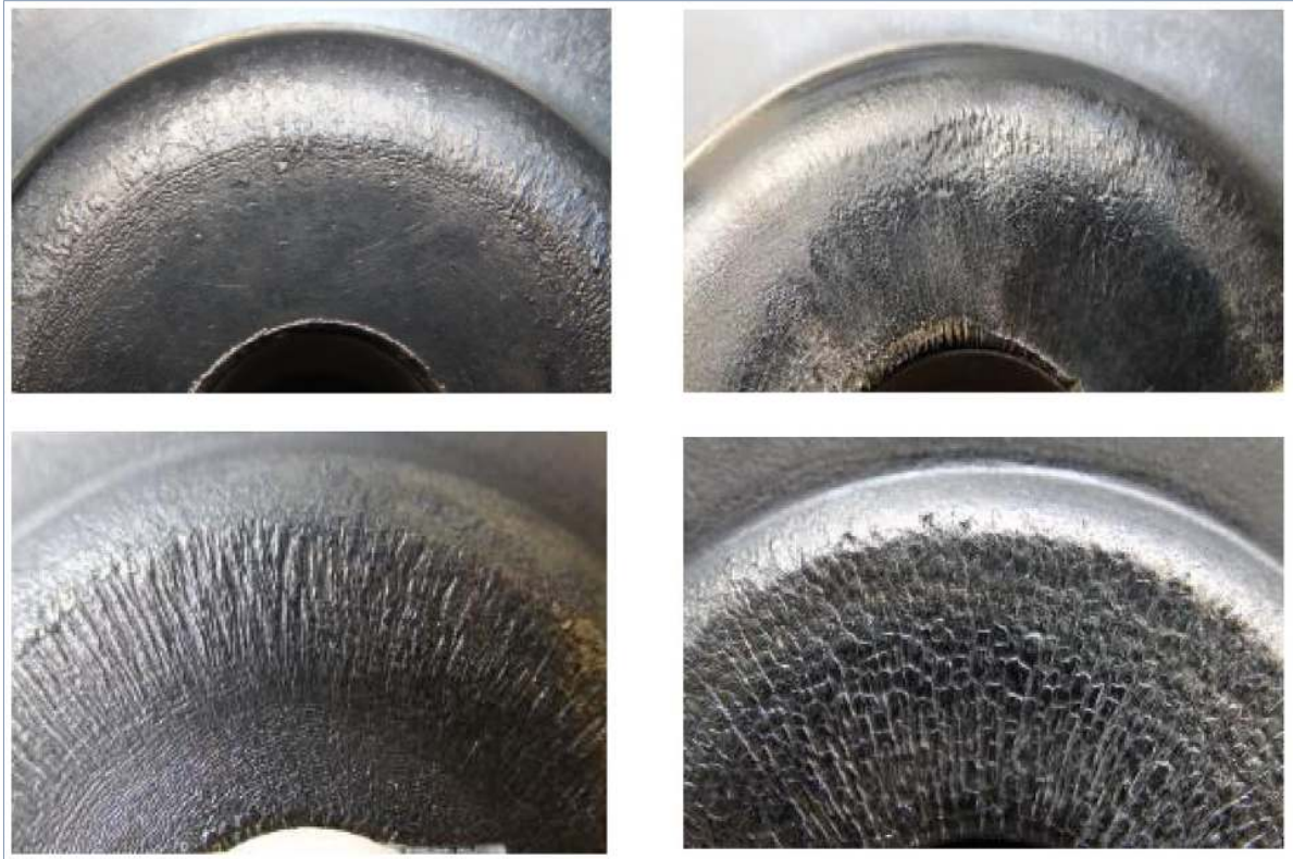
Şekil 37. Dövme kalıplarında meydana gelen termo-mekanik çatlak ağı [76].
