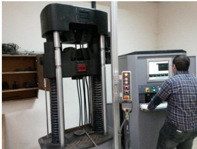
Şekil 4.65 Alınan örnekler üzerinden laboratuvarında çekme testi yapılması.
