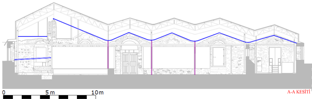
Çatının mertekler üzerindeki üst noktası, giriş kapısından basamakla inilen ilk zeminden itibaren, yükseltilmiş aksta yaklaşık 6,15 metre, diğer akslarda ise yaklaşık 4,20 metre yüksekliğindedir. Çatı açıklıklarının genişliği ZK01 numaralı mekanda ocağın da bulunduğu ve en yüksek çatı örtüsünün bulunduğu aksta 9,90 metre, diğer akslarda ise 4,70 metre, 4,70 metre ve 5,65 metre ölçülerindedir. ZK02 numaralı mekanın üzeri ise yaklaşık 5,45 metre genişliğindeki çatı strüktürü ile geçilmektedir. ZK01 numaralı mekanda çatı strüktürü toplam 6 adet dikme üzerinde yer alan 3 adet güneydoğu-kuzeybatı yönündeki kiriş üzerine oturmaktadır (Şekil 4.32).
