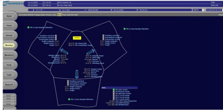
Şekil 1.32. Kanat pitch açısının ayarlanması (Anonim,2025i)
