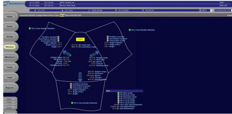
Şekil 1.32. Kanat pitch açısının ayarlanması (Anonim,2025i)
