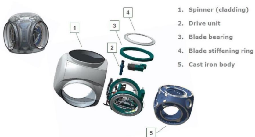
Şekil 1.18. Hub elemanları (Anonim, 2025i)
