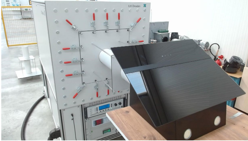
Şekil 3. 1. Davlumbazın performans ölçümü
