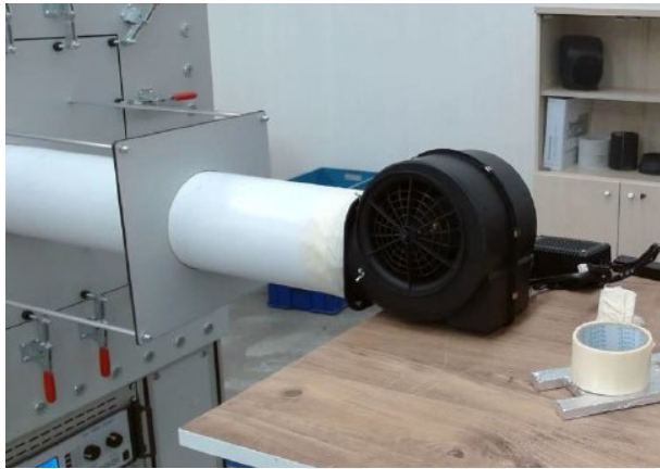
Şekil 4. 4. FXV3 fanın test düzeneği
