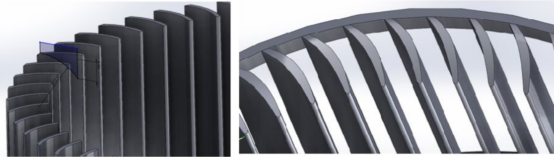
Şekil 3. 10. 59FP90 pervane ucunun keskinliğinin yumuşatılması
