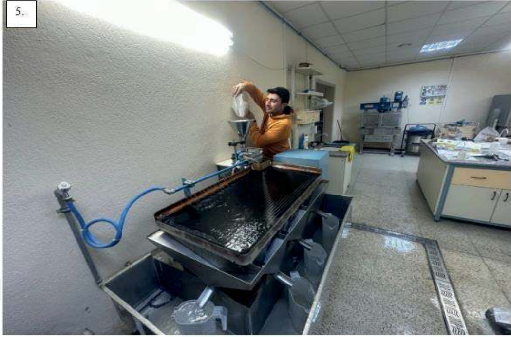
Resim 2.8 Sallantılı masada öğütölmüş örneklere zenginleştirme işlemi
