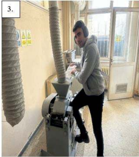
Resim 2.6. Çeneli öğütücü ile kırılmış örneklerin toz haline getirilmesi işlemi.
