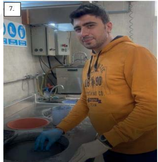
Resim 2.10. İncekesit örneklerine yapıştırılacak camların parlatılması işlemi
