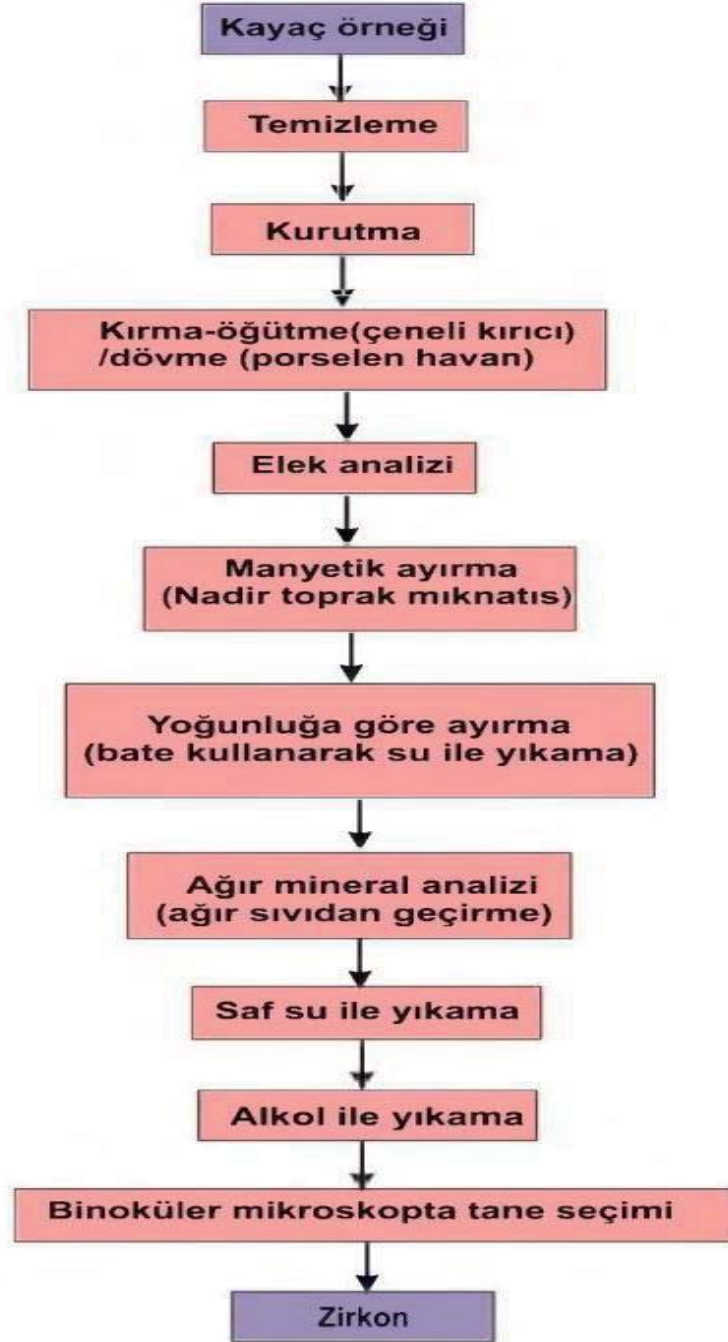
Şekil 2.2. Zirkon minerali ayırma işlemi akış şeması.
