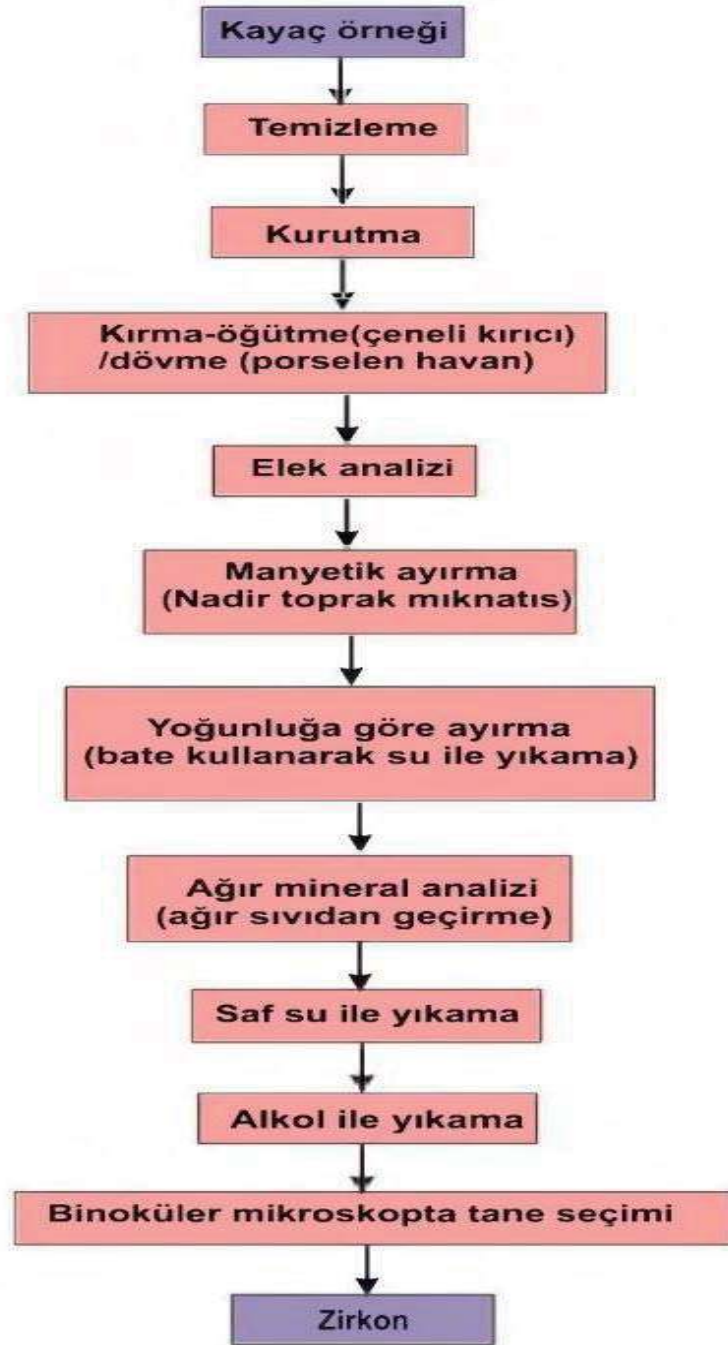
Şekil 2.2. Zirkon minerali ayırma işlemi akış şeması.
