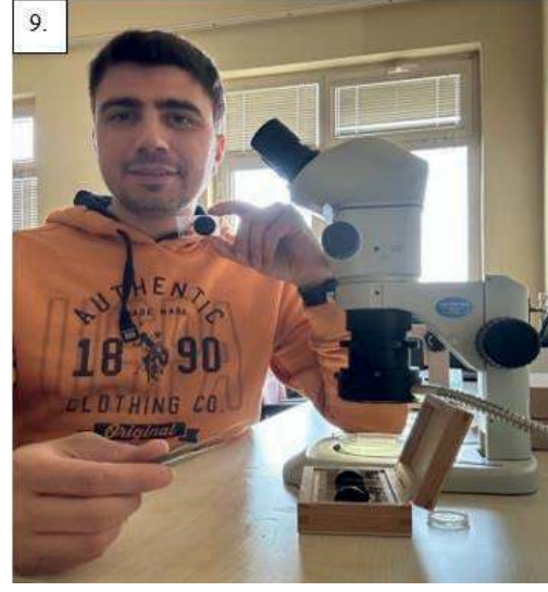
Resim 2.12 Binoküler mikroskop üzerinde Zirkon seçimi.
