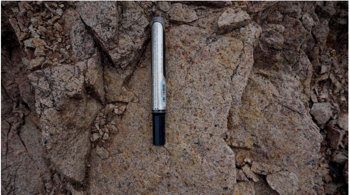
Resim 1.2. 56999 nolu örnek siyenit yakın çekim. (İçerisinde quartz-ortoklas-plajiyoklas-biyotit-sfen-epitod-zirkon-apatit-serüzit-klorit ve opak mineraller bulunduruyor)
