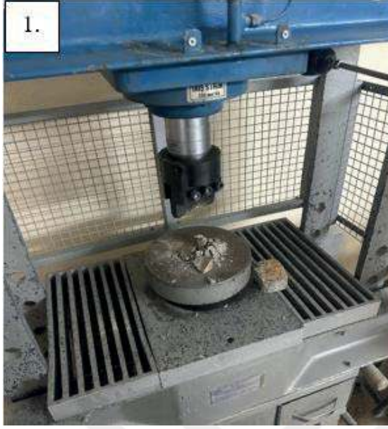
Resim 2.4. Örneklerin kırıcı yardımı ile daha küçük parçalara ayrıştırılması işlemi.
