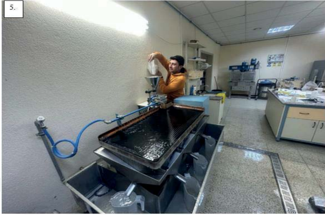
Resim 2.8 Sallantılı masada öğütülmüş örneklerin zenginleştirme işlemi
