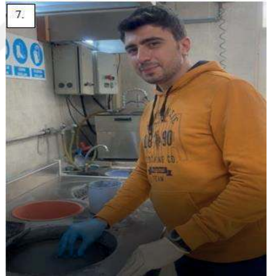
Resim 2.10. İncekesit örneklerine yapıştırılacak camların parlatılması işlemi
