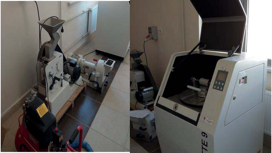
Resim 4.2. Munzur Üniversitemizin laboratuvarında kırma öğütme ve toz haline getirme işleminde kullandığımız çeneli kırıcı-kompressor ve havan öğütücü cihazlarımız.
