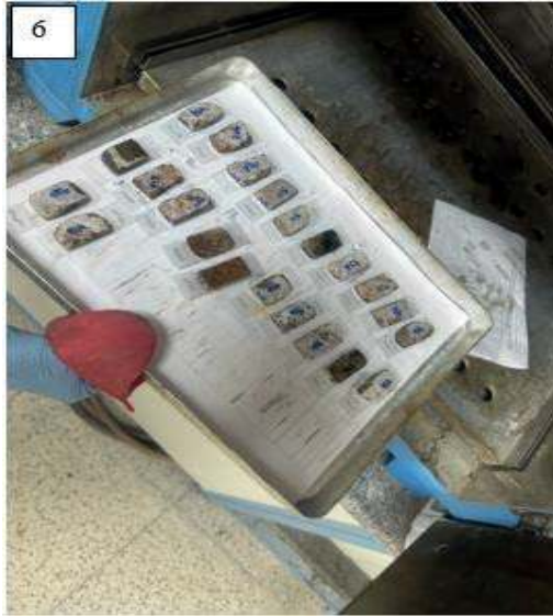
Resim 2.9 İnce kesit için seçilmiş hazırlanan örnekler
