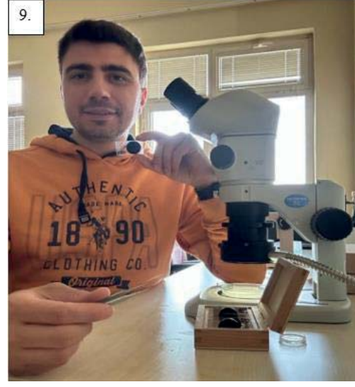
Resim 2.12 Binoküler mikroskop üzerinde Zirkon seçimi.
