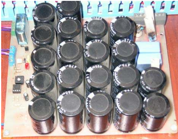
Resim 5.3. Filtreleme kondansatör grubu
