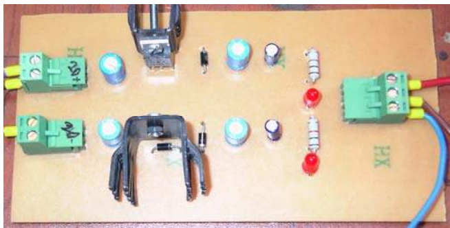
Resim 5.1. Entegreler için +15 V & -15 V besleme kartı
