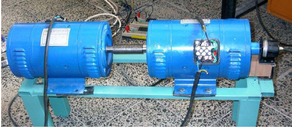
Resim 5.9. DA motorunun dinamo ile akupile bağlantısı
