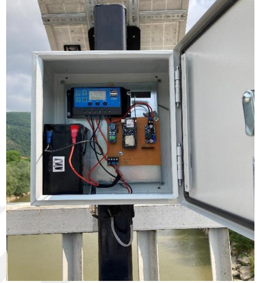
Şekil 5.10. Nehir gözlem istasyonu entegre elemanları kabin görünümü
