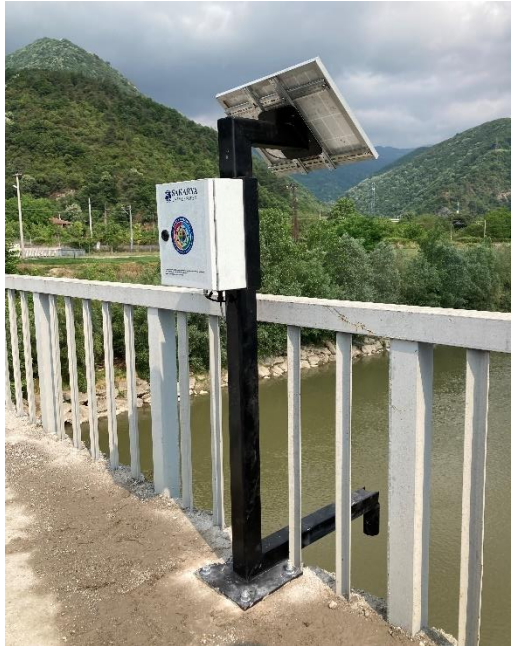
Şekil 5.11. Gerçek zamanlı akım gözlem istasyonu kabin montajı
