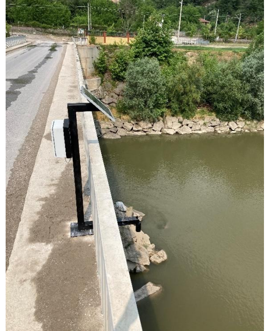
Şekil 5.11. Gerçek zamanlı akım gözlem istasyonu kabin montajı
