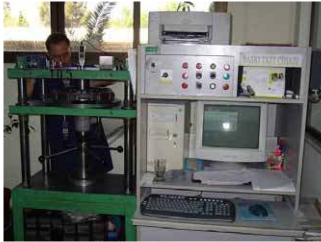
Şekil 3.8 Diyafram yay test cihazı (test sistemi ve donanımı)
