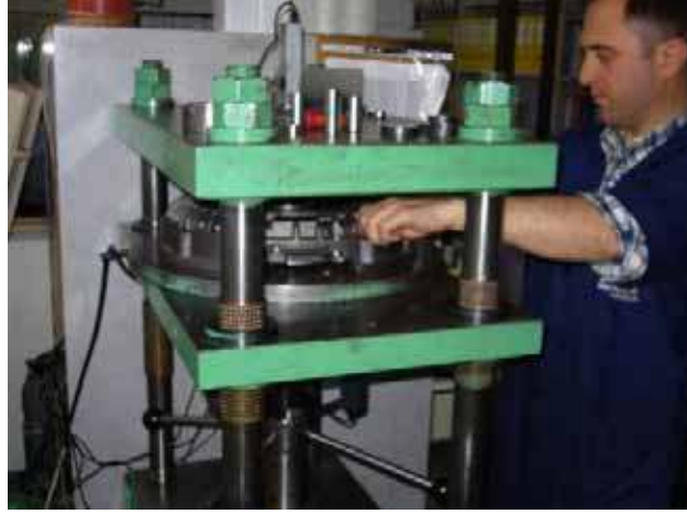
Şekil 3.10 Diyafram yay test cihazı (pedal kuvveti testi)
