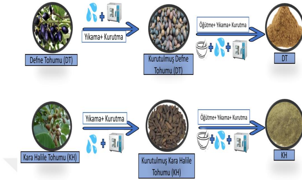
Şekil 3.2. Biyokütelerin ön hazırlık aşaması şematik gösterimi
