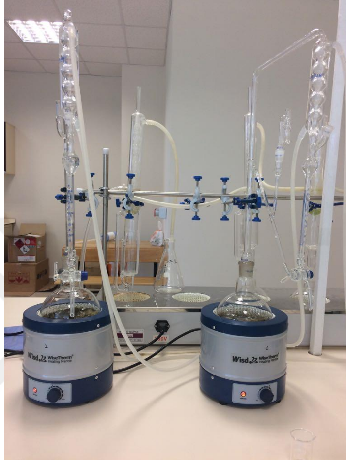
Şekil 3.2. Çalışmada kullanılan Clavenger Düzeneği
