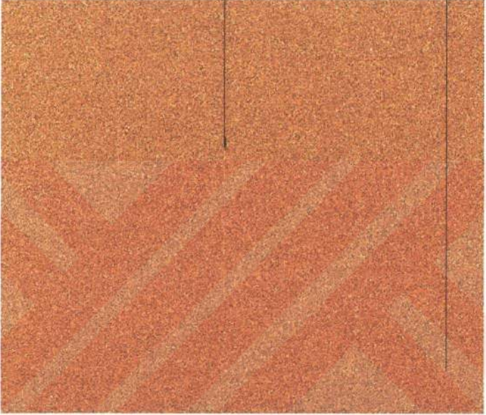
Şekil 3.23 1200 s poz süresinde alınan 20030927_d3 isimi karanlık alan görüntüsü. Burada siyah çizgiler bozuk olan sütunları göstermektedir
