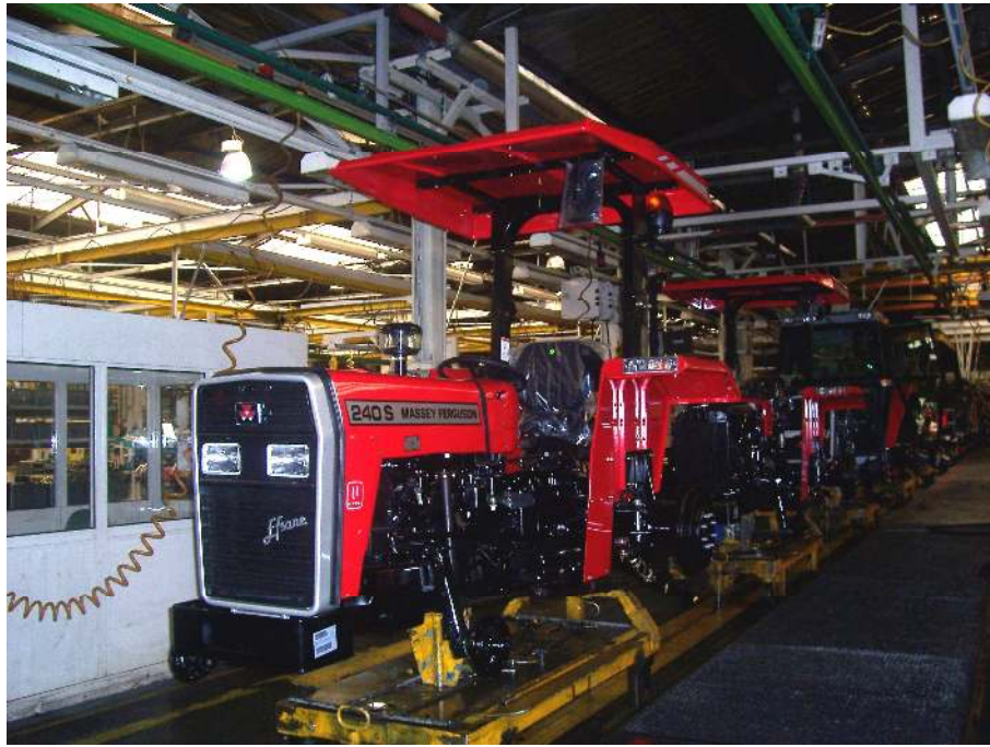
Şekil 6.19. Kaputun 240 S model traktöre montajından sonraki durum
