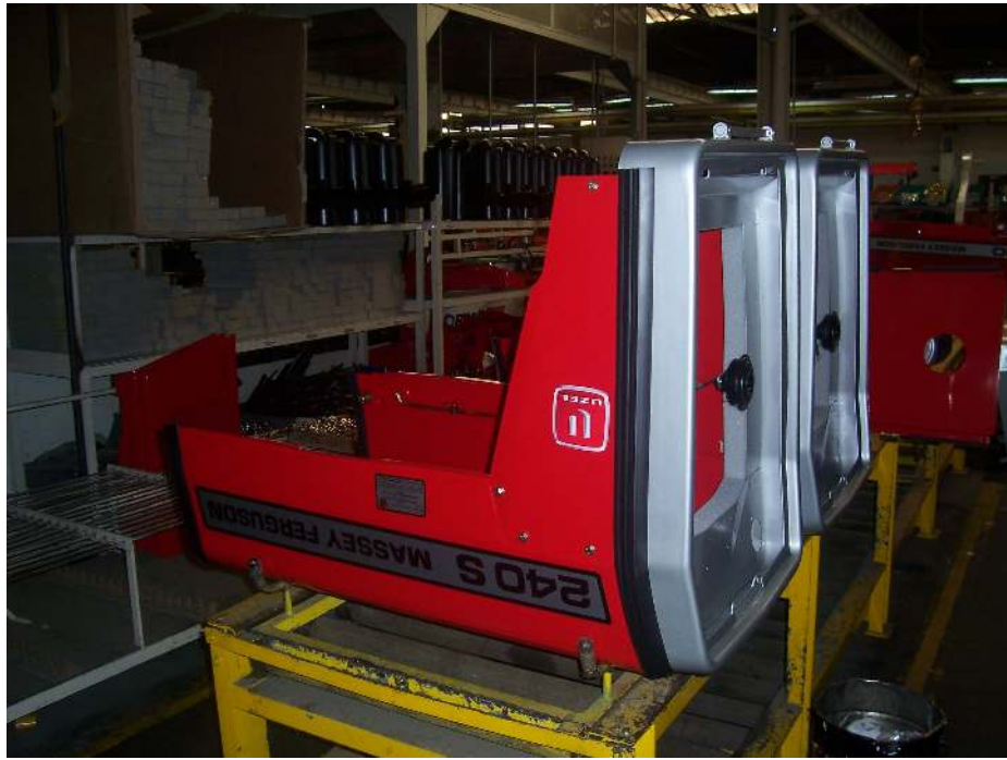
Şekil 6.10. 240 S model traktöre montaj edilen kaput kompleksi
