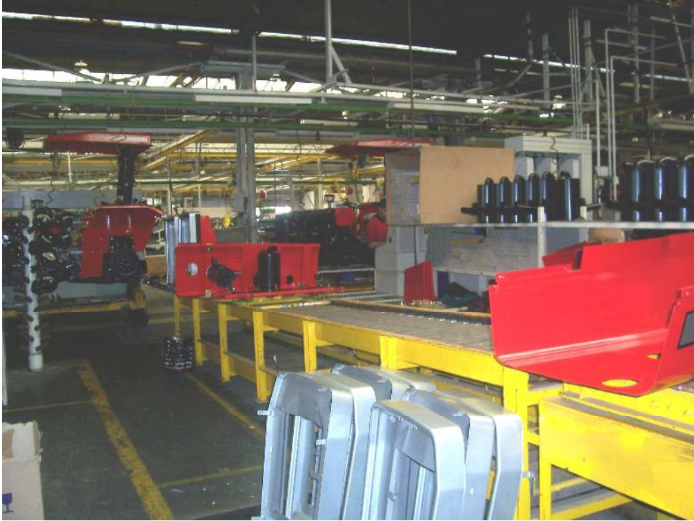
Şekil 6.15. Traktör kaput gövdesinin konveyörlü sisteme yerleştirilmesi
