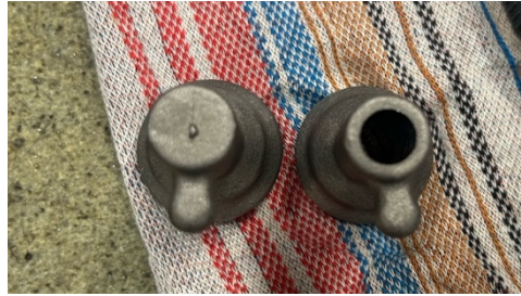
Resim 3.12. İşlenmiş ve işlenmemiş horoz parçalarına ilişkin fotoğraf görüntüsü (Sağ taraftaki parça: işlenmiş, sol taraftaki parça: işlenmemiş)
