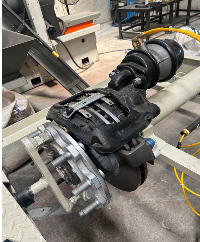
Resim 3.4. Havalı disk fren sisteminin tamamlanmış simülasyon görüntüsü
