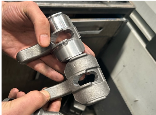
Resim 3.9. İşlenmiş ve işlenmemiş kaşık parçalarına ilişkin fotoğraf görüntüsü (Sol eldeki parça: işlenmiş, sağ eldeki parça: işlenmemiş)
