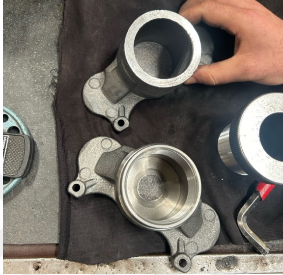
Resim 3.10. İşlenmiş ve işlenmemiş itici parçalara ilişkin fotoğraf görüntüsü (Fotoğrafın üst kısmındaki parça: işlenmiş, fotoğrafın alt kısmındaki parça: işlenmemiş)
