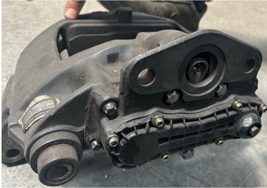
Resim 3.6. Birleştirilmiş kaliper ve köprünün görüntüsü
