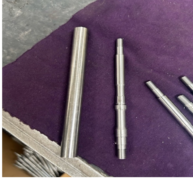
Resim 3.11. İşlenmiş ve işlenmemiş mil parçasına ilişkin fotoğraf görüntüsü (Sağ taraftaki parça: işlenmiş, sol taraftaki parça: işlenmemiş)
