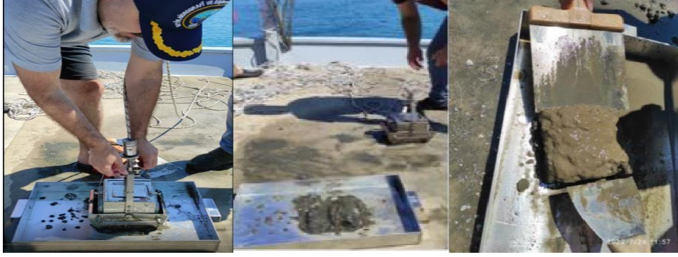
Şekil 3. Ekman Grap ile sediman örnekleme
