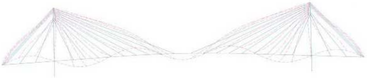
Şekil 9. Köprü sistemine ait mod şekilleri
