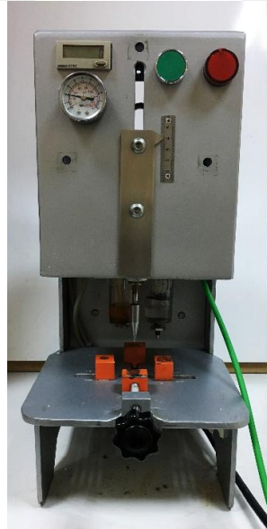
Şekil 2. Kapalı çevrimli kontrollü, düşük çevrimli, 10N kapasiteli ve 300 mm/dk hıza sahip yorulma makinesi
