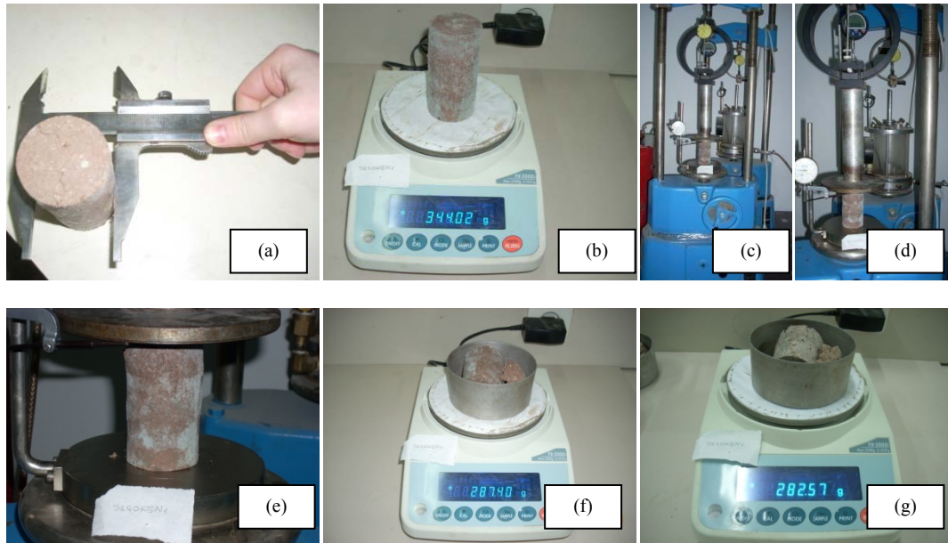
Resim 4.3. Serbest basınç deneyi aşamaları a) Kumpas yardımıyla numune boy ve çapının ölçülmesi b) Numunenin deney öncesi ağırlığının tartılması c) Numunenin düzeneğe yerleşmiş hali d) Deneyin başlaması e) Numunede oluşan kırılma çizgileri f) Deney sonrası numunenin yaş ağırlığının ölçülmesi g) Etüvde kurutulmuş numunenin kuru ağırlığının ölçülmesi
